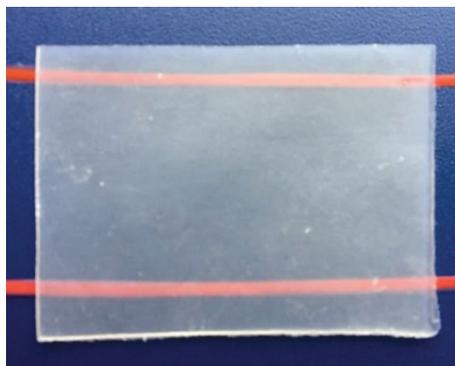
**Figura 3.2.** Mezcla biopolimérica posterior al moldeo por compresión
