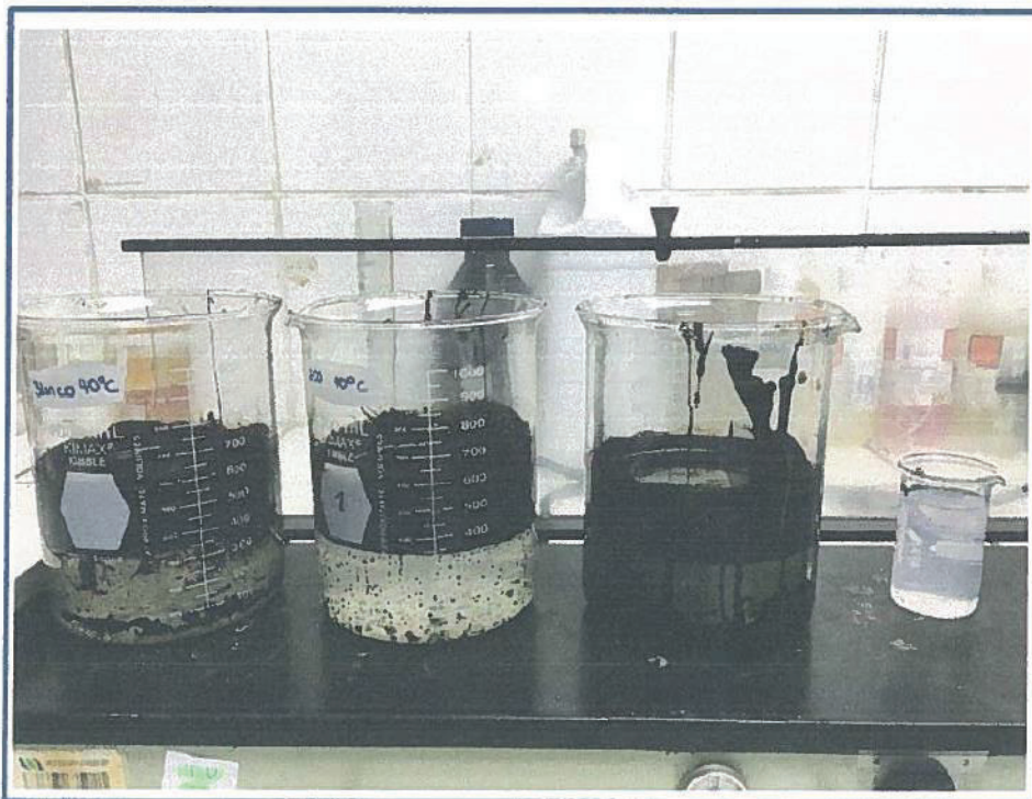
Foto 15: Prueba de compatibilidad con fluido de producción a 40 °C después de 24 horas, el vaso pequeño muestra agua con 3 gotas de w20
