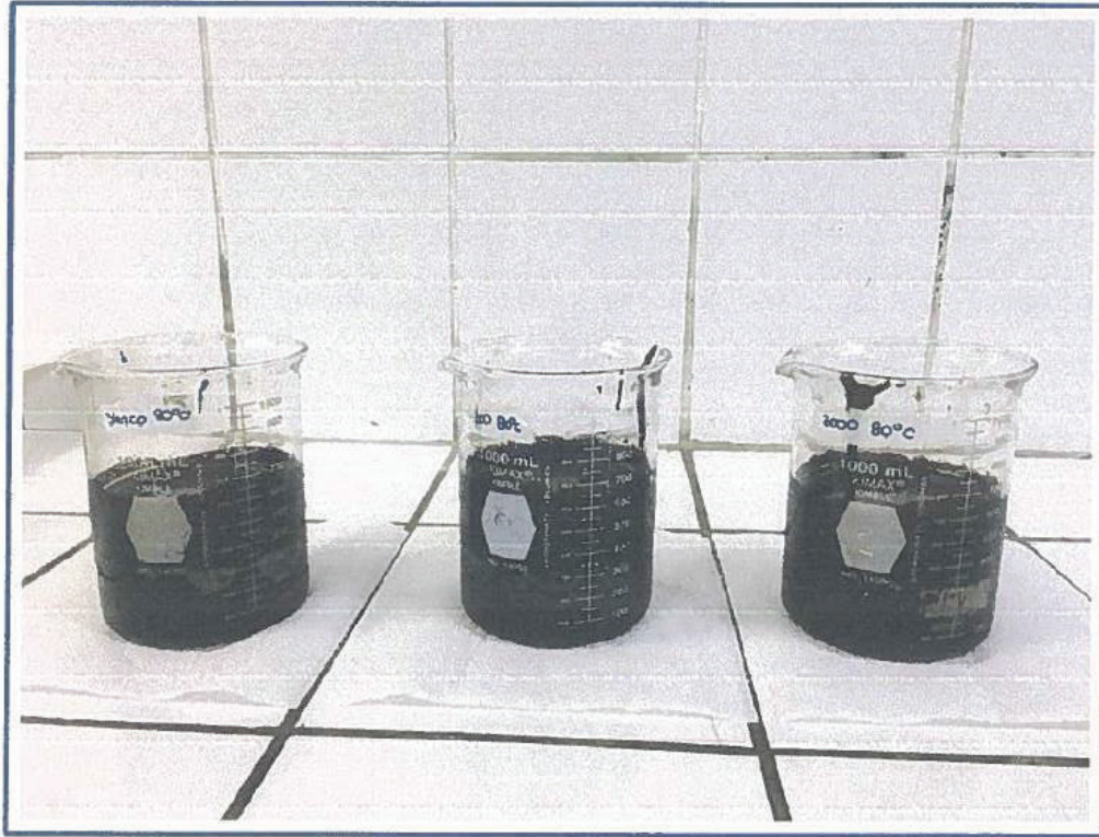
Foto 16: Prueba de compatibilidad con fluido de producción a 80 °C después de 24 horas
