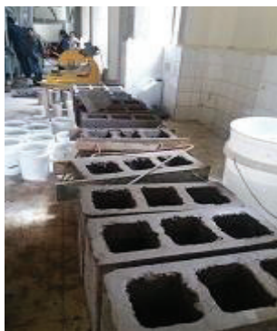
Bloques refrendados para ensayo (24 horas)
