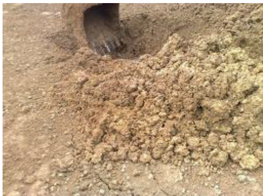
Foto. 5, Cuchara obteniendo muestra
