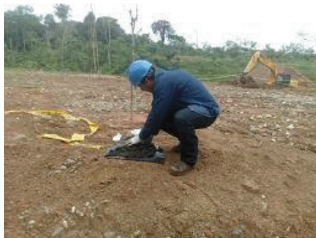
Foto. 5, Cuchara obteniendo muestra
