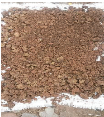
Lodo granulometría 5cm – 1 cm Secado natural.
