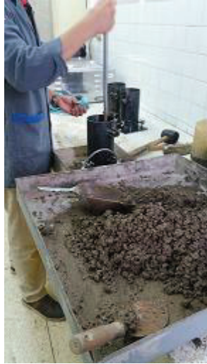
Mezcla de hormigón (probetas)
