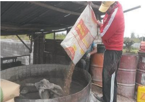
Se añade el lodo de perforación de 2cm – 1/8pulg
