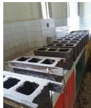
Bloques refrendados para ensayo (24 horas)
