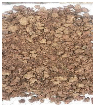
Lodo granulometría 7cm – 5cm Secado Natural.
