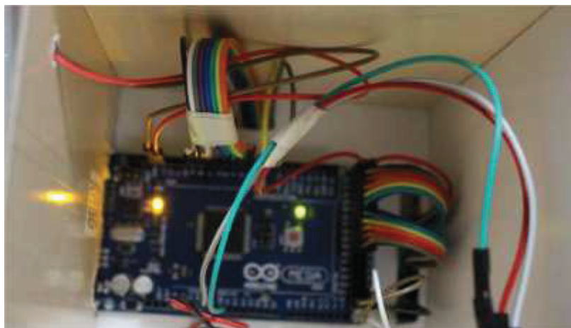
Figura 3.4. Encendido del led de la placa Arduino.
