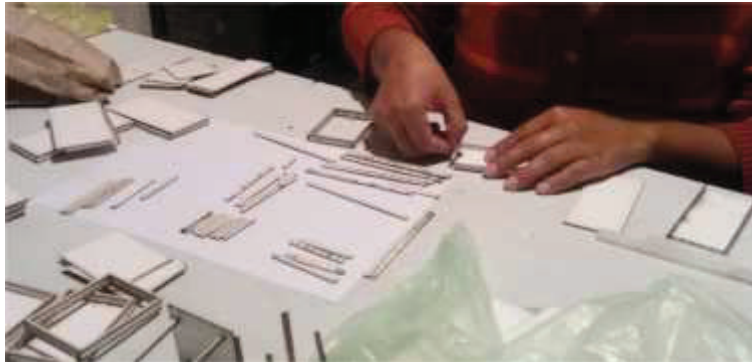
Figura 2.18. Colocación del imán en puertas y ventanas.
