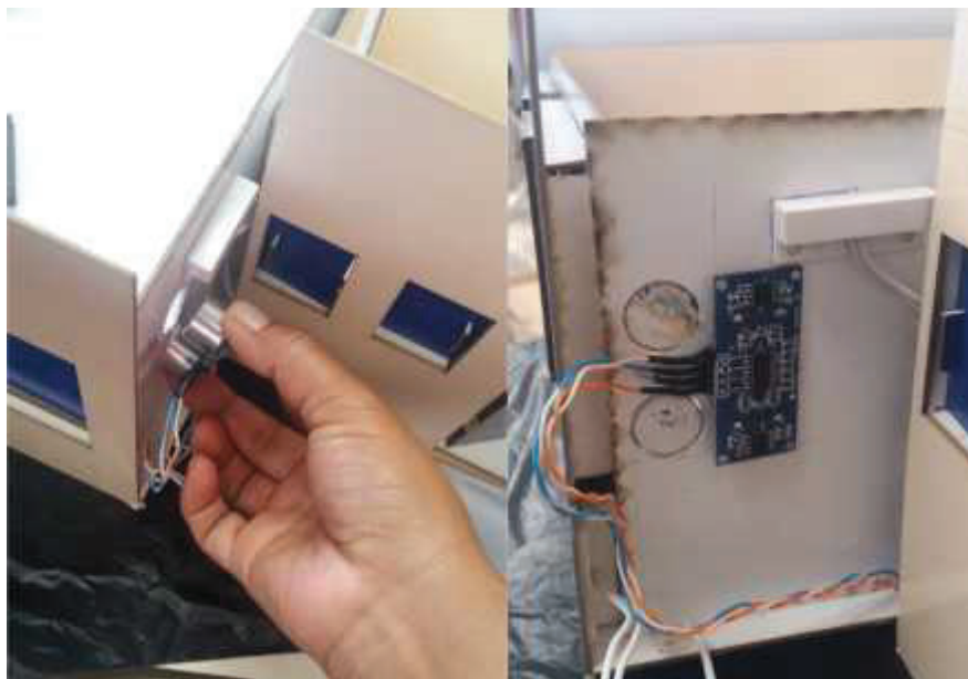
Figura 2.20. Instalación de sensor ultrasónico
