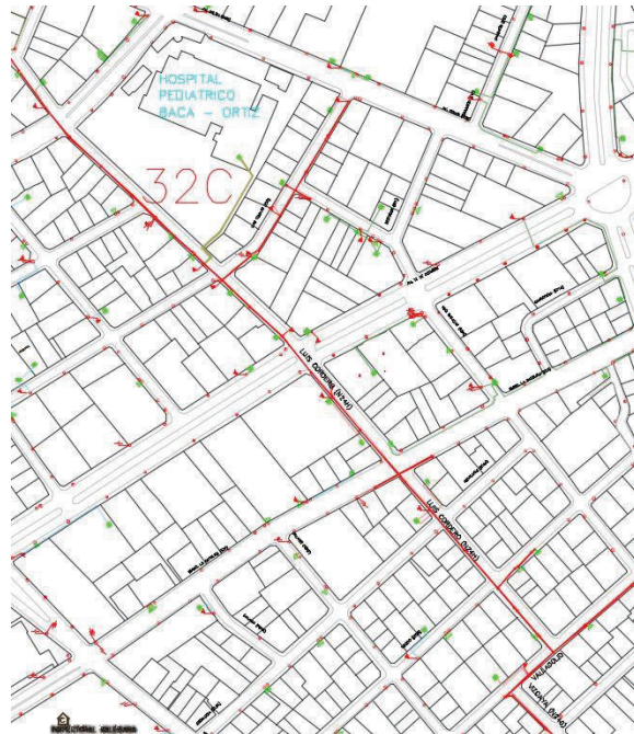
Figura 3.14. Alimentador 32 C de la Subestación 10 Nueva EEQ. (Fuente: EEQ, GIS, 2015).
