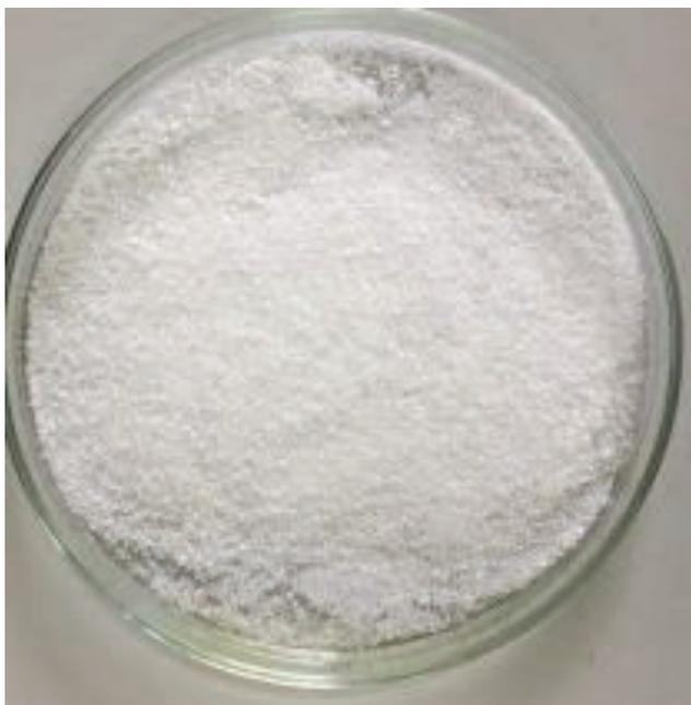
**Figura 3.1.** Almidón de oca obtenido del proceso de extracción
