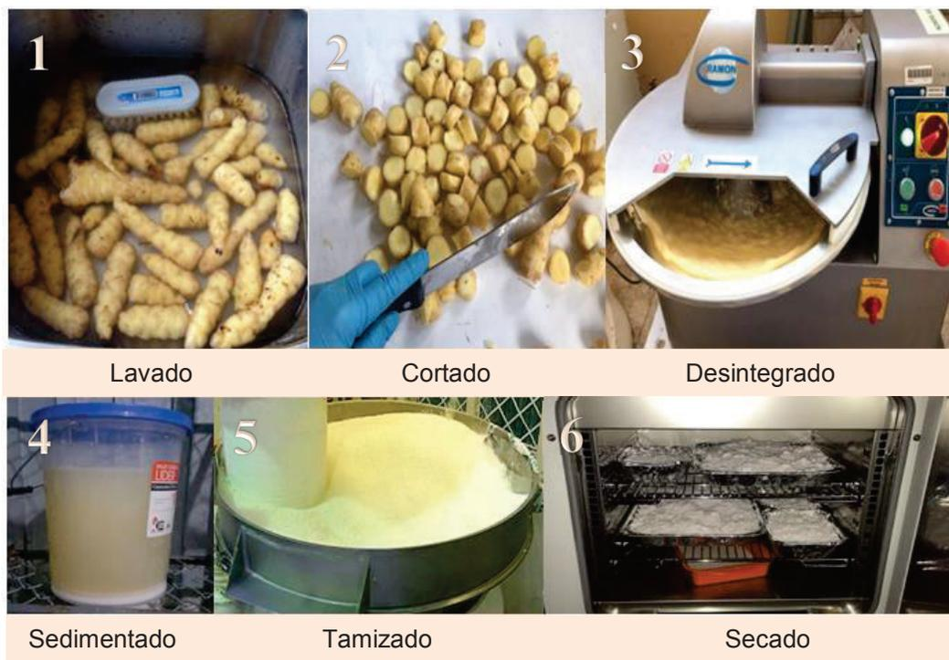
**Figura 2.2.** Proceso de extracción de carbohidratos de oca
