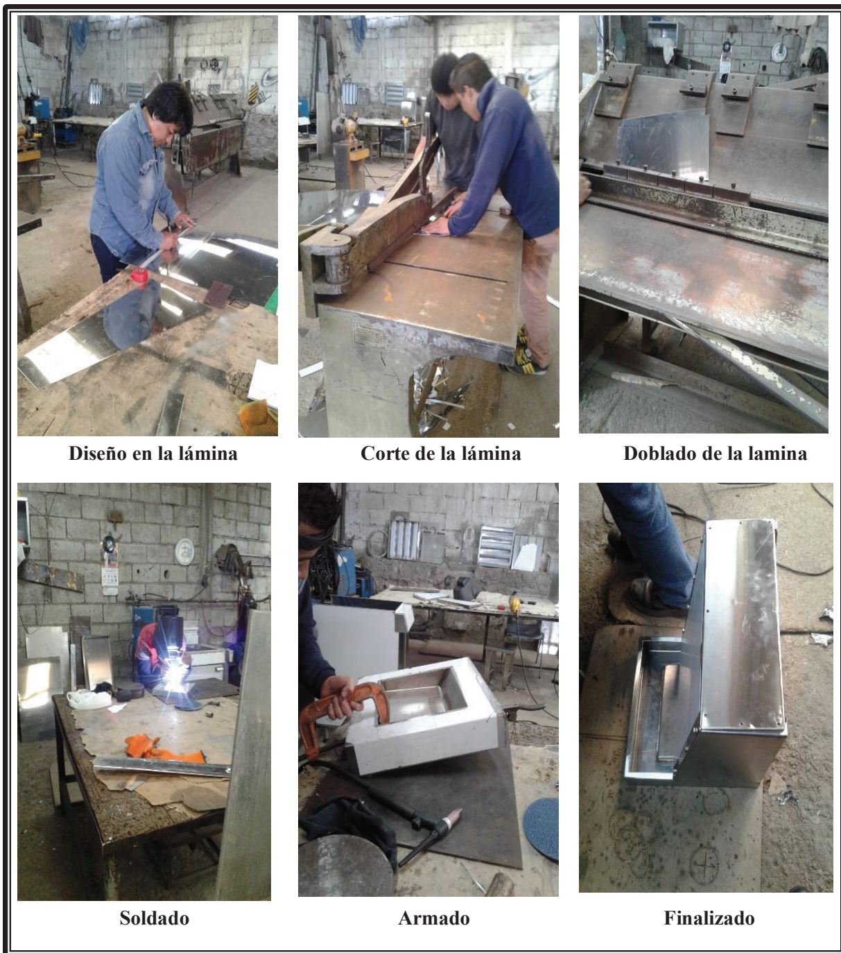
Figura 12. Construcción del bebedero
