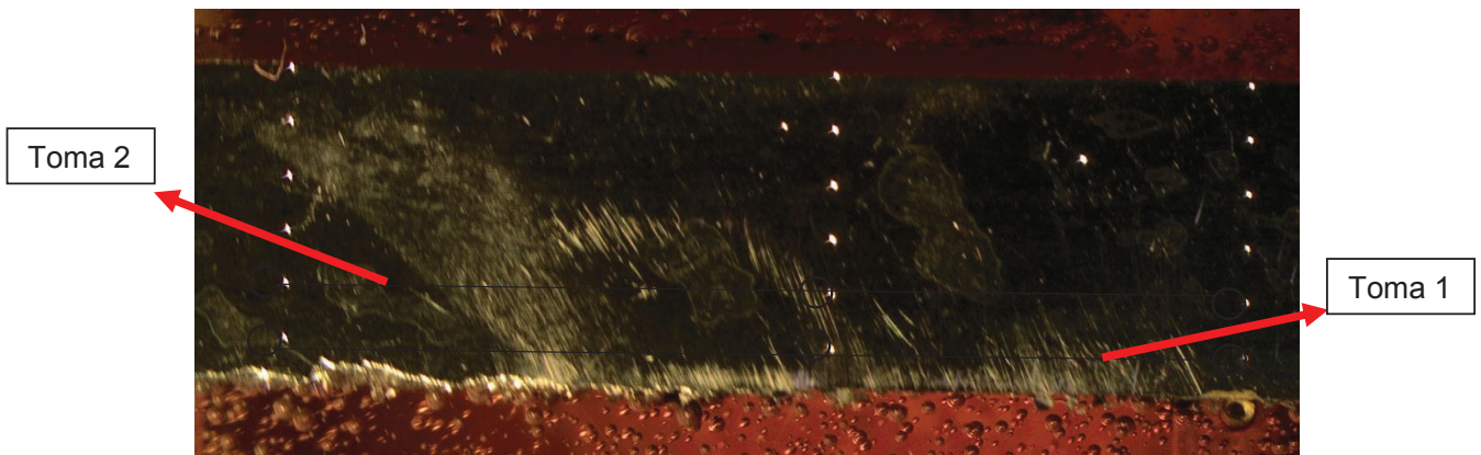
Figura 3.17. Posiciones y tomas para el ensayo de dureza. Fuente: Propia
