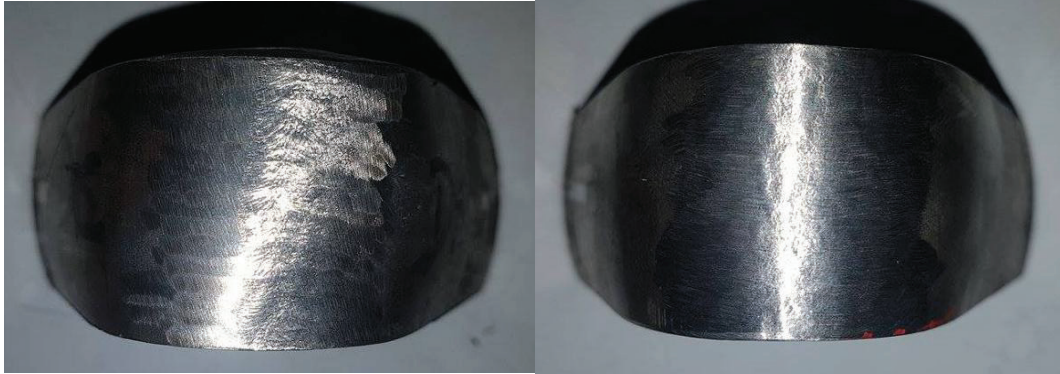
Figura 3.3. Probetas ensayadas (doblado de cara). Fuente: Propia
