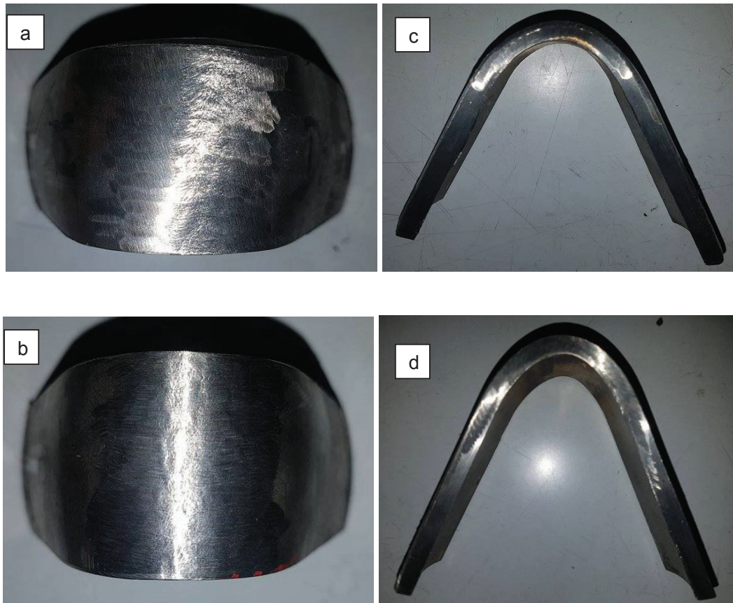
Figura 3.23. (a) Probeta 1 vista superior (b) Probeta 2 vista superior (c) Probeta 1 vista lateral (d) Probeta 2 vista lateral Doblando de Cara.
