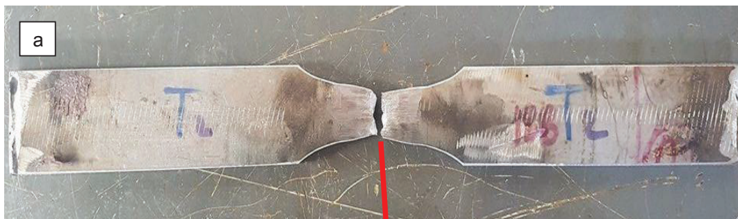
Figura 3.1. Fractura de la probeta T1. (a) Cara Frontal (b) Cara Posterior. Fuente: Propia
