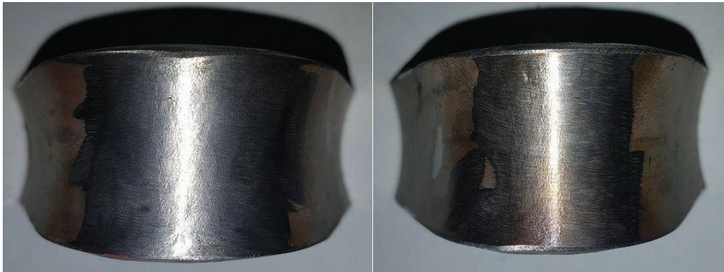
Figura 3.4. Probetas ensayadas (doblado de raíz). Fuente: Propia
