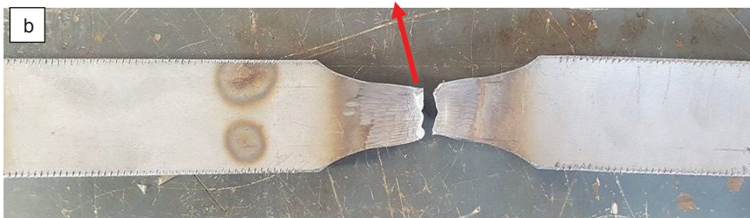
Figura 3.2. Fractura de la probeta T2. (a) Cara Frontal (b) Cara Posterior. Fuente: Propia
