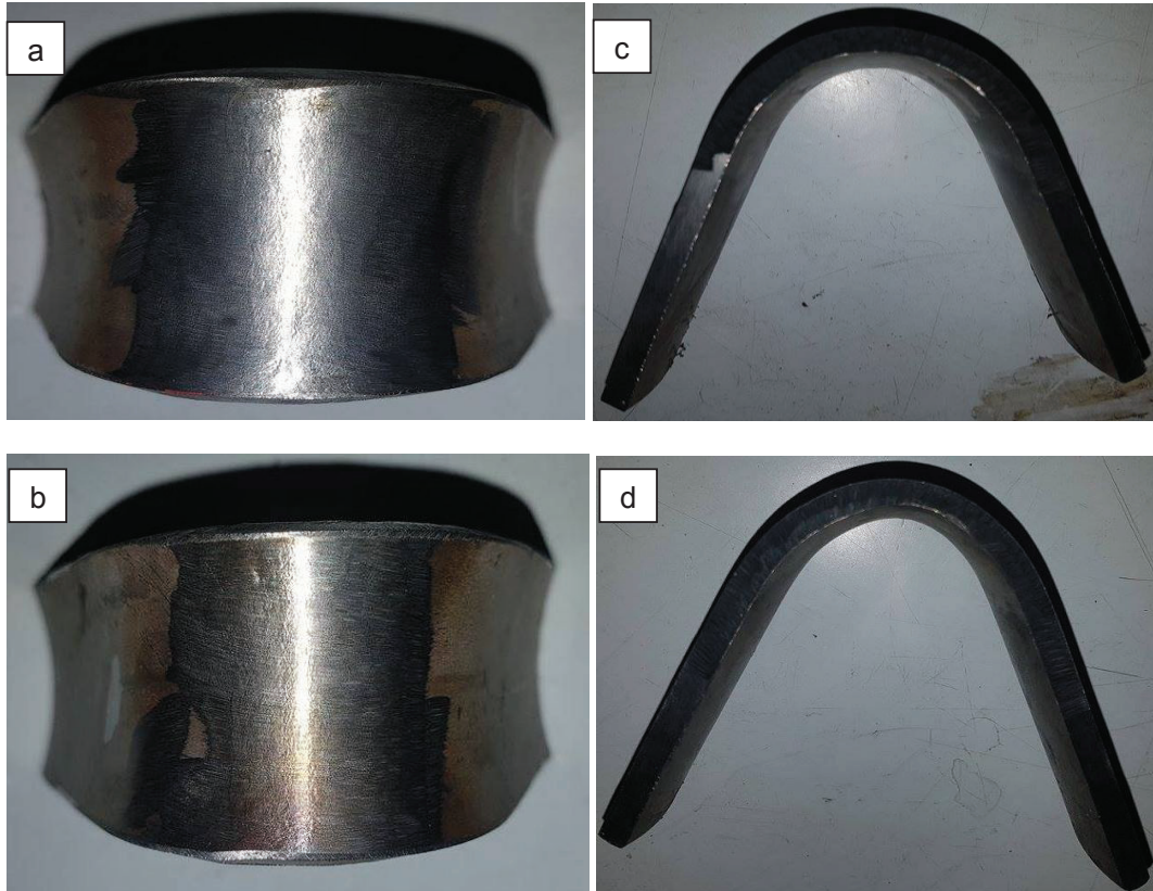
Figura 3.24. (a) Probeta 1 vista superior (b) Probeta 2 vista superior (c) Probeta 1 vista lateral (d) Probeta 2 vista lateral Doblado de Raíz.
