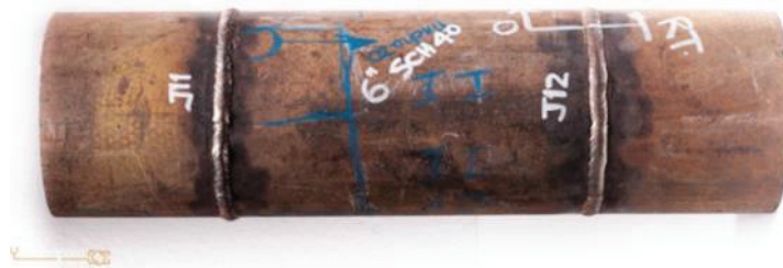
Figura 48. Cupón de prueba soldado 6" SCH STD- Proceso SMAW (Fuente: Oscar Yanchapaxi-2017)
