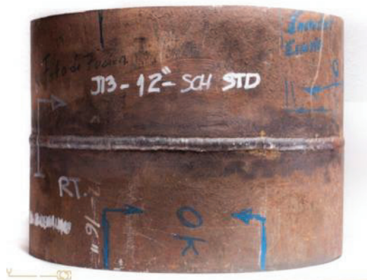
Figura 49. Cupón de prueba soldado 12" SCH STD- Proceso SMAW (Fuente: Oscar Yanchapaxi-2017)
