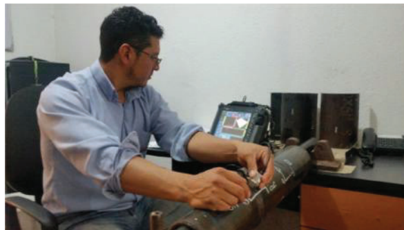
Figura 50. Inspección mediante ultrasonido arreglo de fases – cupones de prueba (Fuente: Oscar Yanchapaxi-2017)
