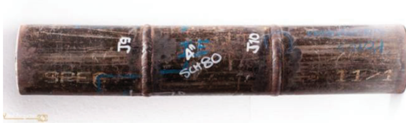
Figura 47. Cupón de prueba soldado 4" SCH 80- Proceso SMAW (Fuente: Oscar Yanchapaxi-2017)
