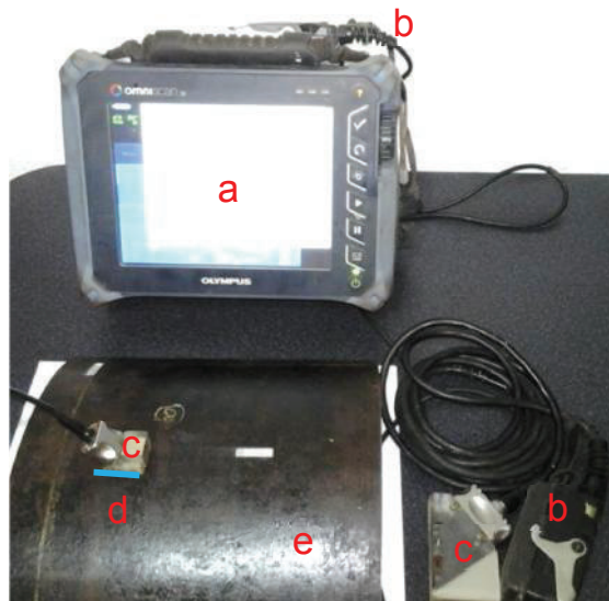
Figura 29. Sistema de inspección ultrasónica (Fuente: Oscar Yanchapaxi, 2016)
