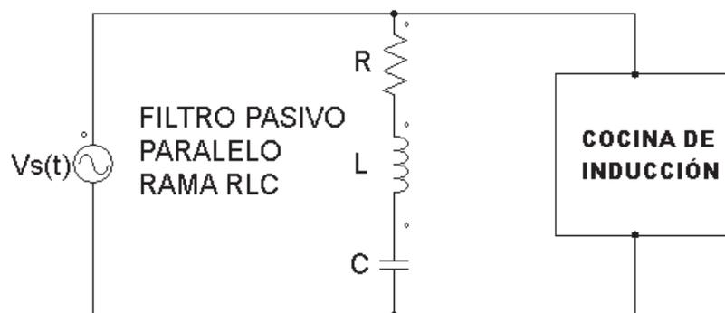
**Figura 3.6.** Rama RLC del filtro pasivo conexión paralelo
