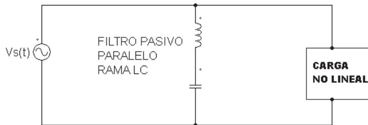
**Figura 3.1.** Conexión del filtro pasivo
