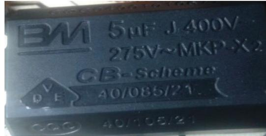
**Figura 1.17.** Capacitor del filtro LC de la cocina de inducción comercial
