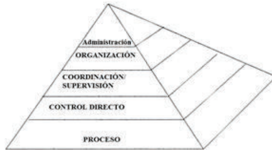
Figura 1. Pirámide de automatización [3]
