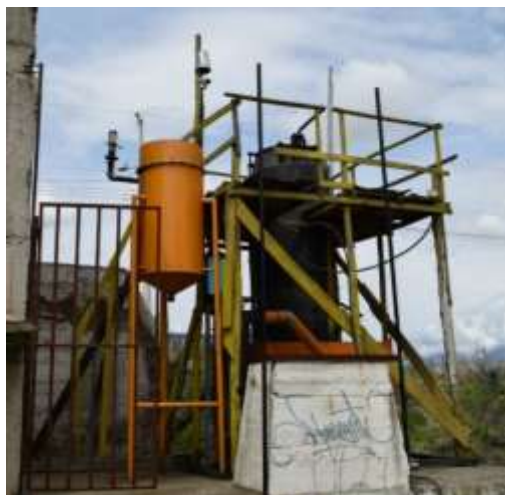
Figura 2.10. Gasificador downdraft ESPOCH. (Fuente: Propia)
