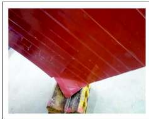
FIGURA 3.15 FALLA POR APLASTAMIENTO OBTENIDO A TRACCIÓN DIAGONAL
