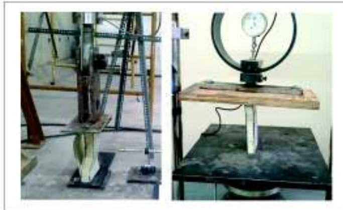
FIGURA 3.8 ENSAYO A COMPRESIÓN PARALELA
