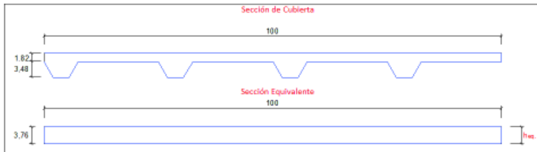
FIGURA 4.6 SECCIÓN DE CUBIERTA REAL Y EQUIVALENTE
