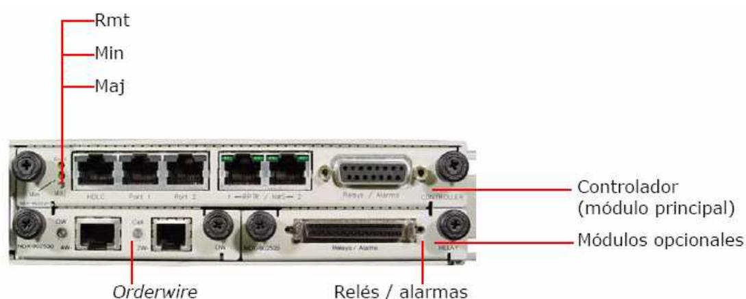
Fig. 2.15 Módulo controlador del SPU
