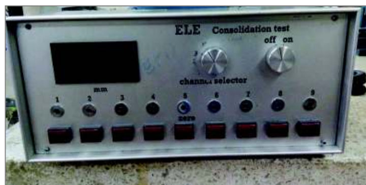
FOTOGRAFÍA 4.3 DEFORMÍMETROS DE CAPACIDAD DE 0.01 MM.
