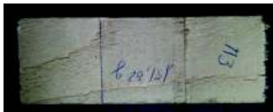
FOTOGRAFÍA 5.2 FALLA POR COMPRESIÓN PERPENDICULAR A LA FIBRA.
