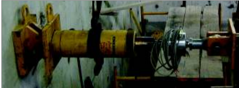
FOTOGRAFÍA 4.12 GATO HIDRÁULICO DE CARGA CÍCLICA CON CAPACIDAD DE 100TN.
