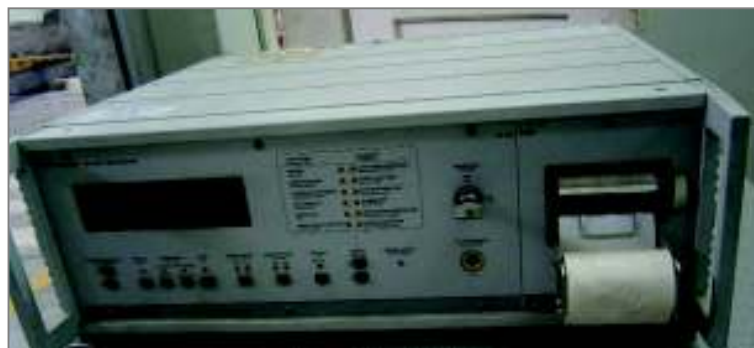
FOTOGRAFÍA 4.14 SISTEMA UPM100 HBM DE 80 CANALES PARA RECOPIACIÓN DE DATOS DE CARGA Y DESPLAZAMIENTO.
