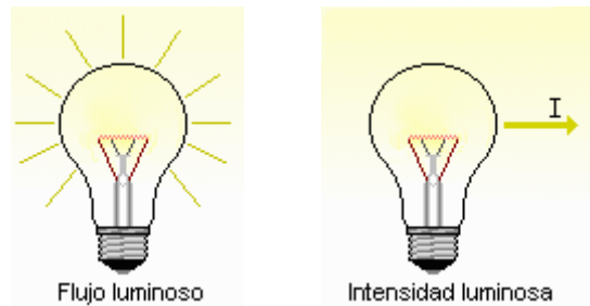
Fig. 1.3 Diferencia entre flujo e intensidad luminosa
