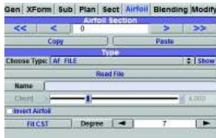
Figura III.5. Procedimiento para insertar un perfil aerodinámico.
