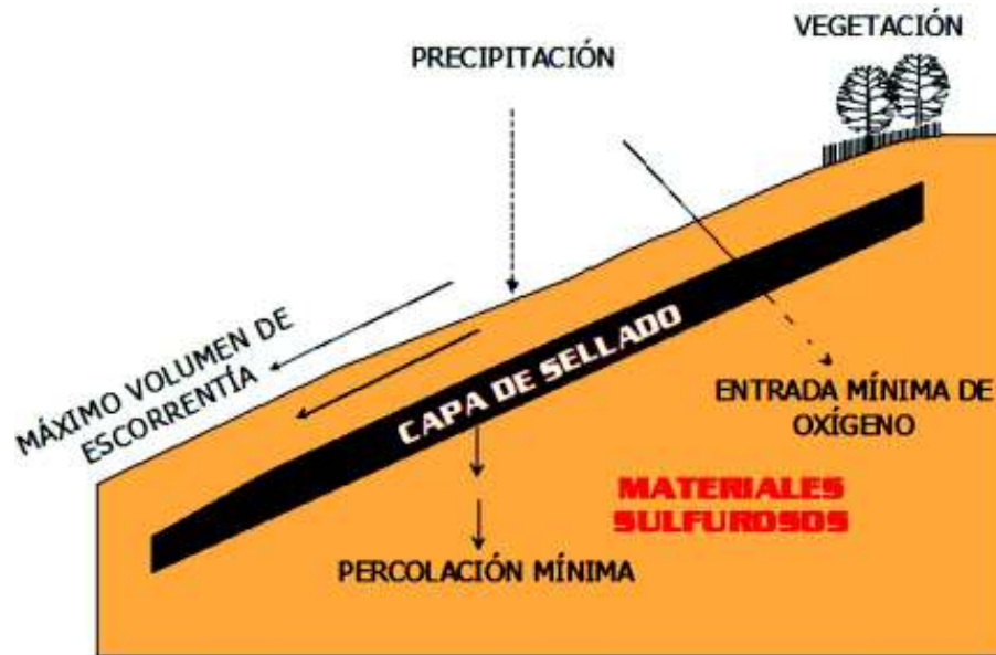
FIGURA 2.3 RECUBRIMIENTO Y SELLADO DE MATERIALES PARA PREVENIR LA FORMACIÓN DE DRENAJE ÁCIDO DE MINA
