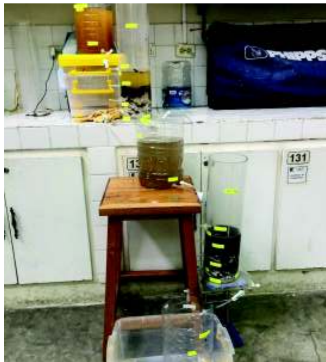
FIGURA 3.6 SISTEMA DE TRATAMIENTO TIPO SUSTRATO ALCALINO DISPERSO PROPUESTO EN ESTA INVESTIGACIÓN
