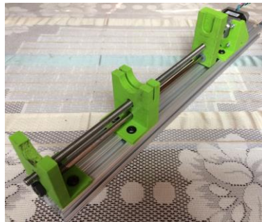
Figura 2.48. Montaje de motor, guía y tornillo de potencia. (Fuente: Propia)
