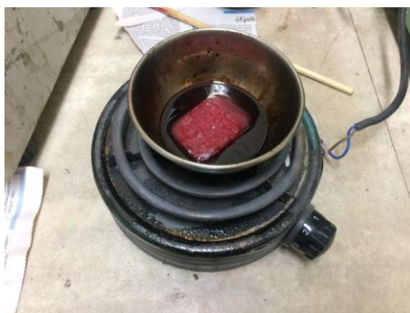
Figura 3.1. Fundición de la mezcla 1 (100% cera en base de savia de látex). (Fuente: Propia)
