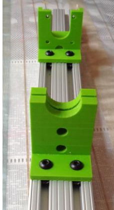
Figura 2.47. Piezas de soporte montadas sobre el riel. (Fuente: Propia)
