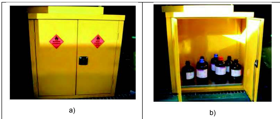
Figura 3.6. a) Cabina de seguridad; b) Dentro de la cabina de seguridad.
