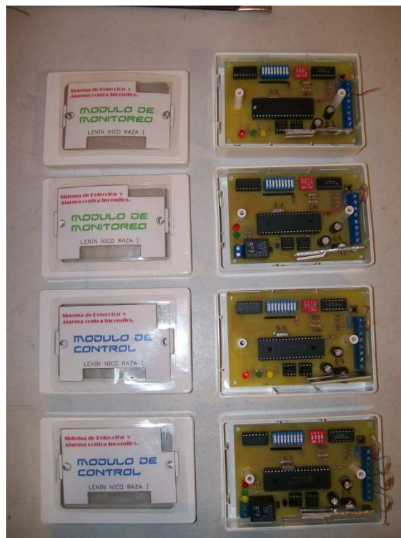
Figura 4.14 Módulos de monitoreo y control.
