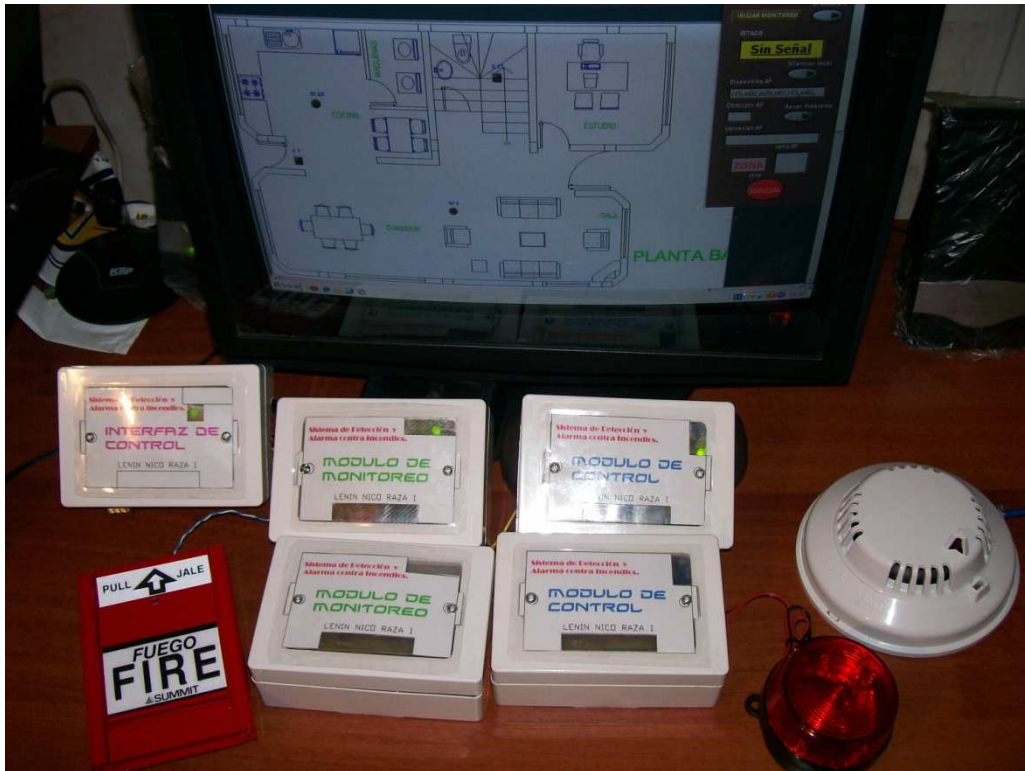
Figura 4.15 Elementos que componen el sistema de detección y alarma contra incendios.
