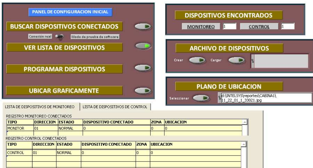
Figura 4.2 Prueba 2, con 1 módulo de monitoreo y 1 módulo de control conectados.
