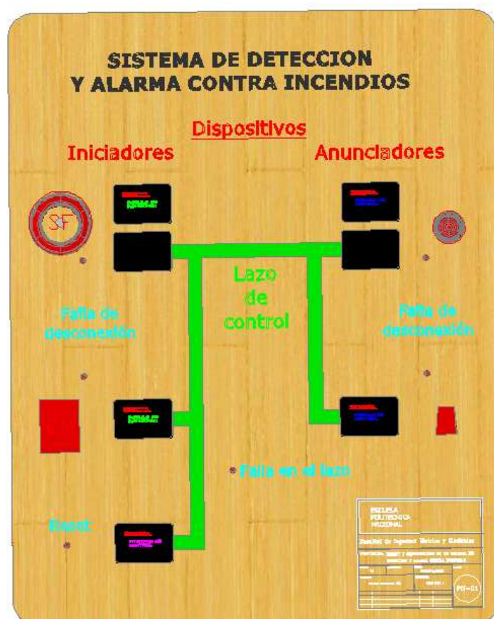
Figura D.1 Vista superior del panel de presentación.
