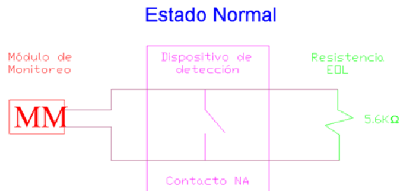
Figura 1.9 Estado normal de Módulo de Monitoreo
