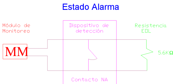
Figura 1.10 Estado alarma de Módulo de Monitoreo
