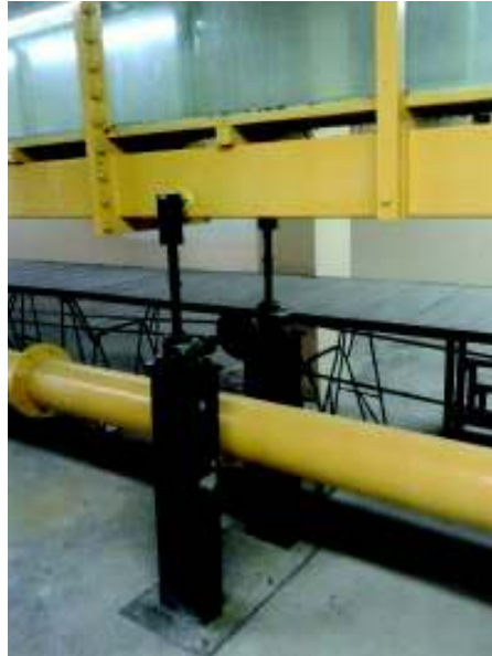
Figura 3. 6: Estructura soportante del canal
