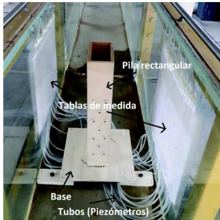
Figura 3. 11: Estructura utilizada para los experimentos
