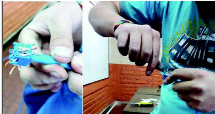
**Figura 17. Ubicación de hilos y corte**
