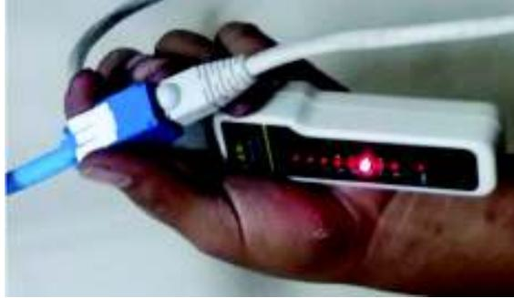
Figura 22. Pruebas con el LAN tester en uno de los puntos de red instalados
