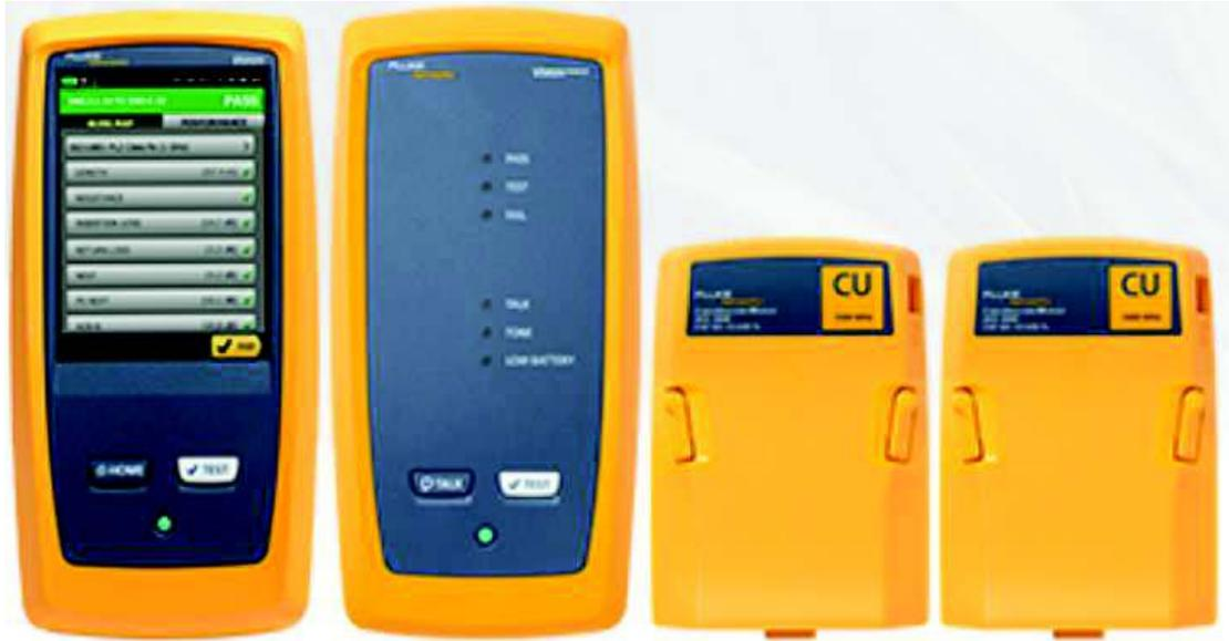
Figura 23. Equipo certificador FLUKE DSX-5000 (Networks, 2017)
