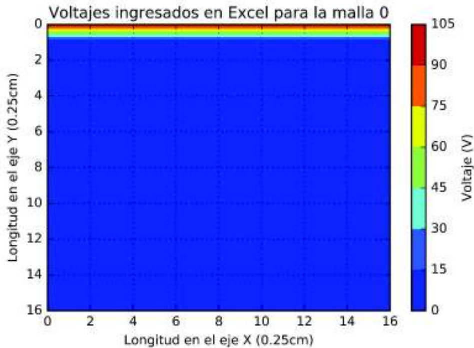
Figura I.11 Gráfico de los valores de voltaje ingresados en Excel para el modelamiento del problema simétrico de teoría electromagnética [Resultado obtenido por CEDIF].
