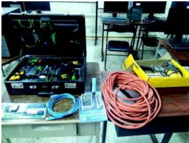
Figura 42. Equipo y herramientas para la instalación del cableado estructurado y cámaras IP (Sanchez & Moya, 2017)
