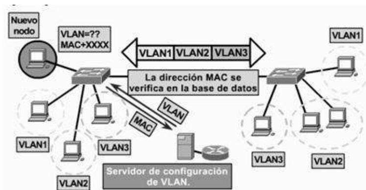
Figura 6. VLAN Dinámica (Smerlin, 2017)
