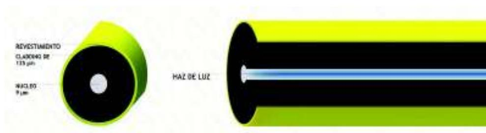
Figura 15. Fibra óptica monomodo (BEYONDTECH, 2017)
