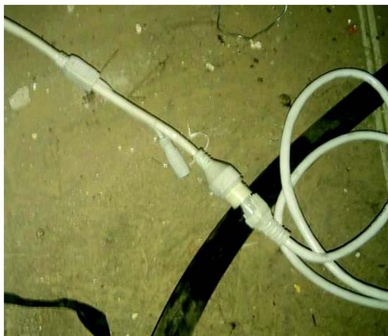
*Figura 46. Conexión entre Patchcord y jack RJ45 (Sanchez & Moya, 2017)*
