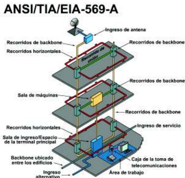
Figura 19. Componentes de la infraestructura de una SCE - ANSI/TIA/EIA-569-C (Palomeque, 2017)
