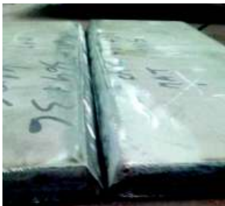
Fig. 2.9. Placas biseladas. (Fuente propia)
