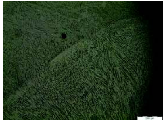
Fig. 3.6. Micrografía del otro extremo del cordón de soldadura. Fotografía tomada entre pase y pase de cordón. La estructura consiste en una matriz austenítica con granos en crecimiento columnar. Ampliación: 100x.
