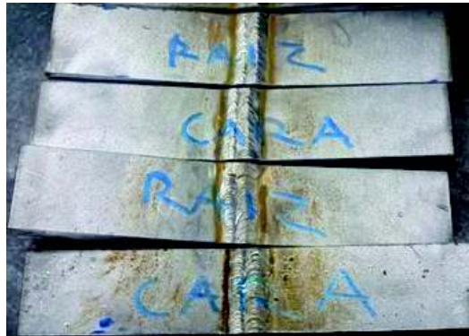
Fig. 2.25. Probetas para el ensayo de doblado. (Fuente propia)
