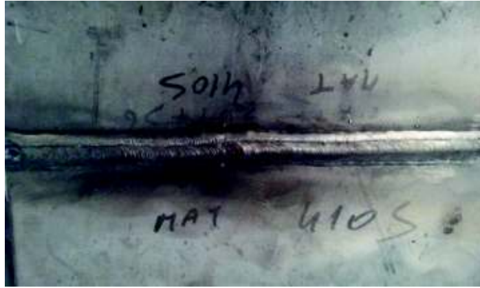
Fig. 2.16. Probeta para el ensayo de radiografía. (Fuente propia)
