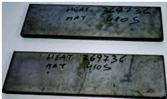
Fig. 2.6. Placas de acero inoxidable ferrítico 410S.
