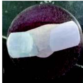
Fig. 2.19. Probeta de un extremo del cordón de soldadura utilizada para los estudios metalográficos. (Fuente propia)
