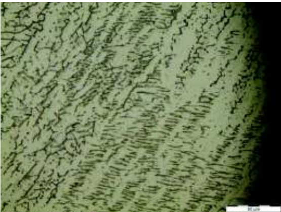
Fig. 3.5. Micrografía del cordón de soldadura de un extremo de la probeta, con un material de aporte 308L. La estructura consiste en una matriz austenítica con granos en crecimiento columnar. Amplificación 500x.
