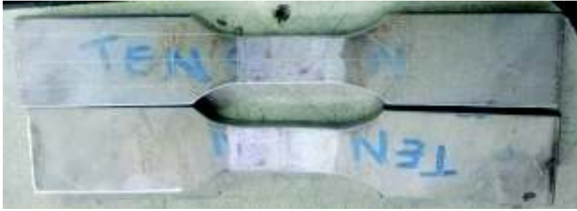
Fig. 2.22. Probetas para el ensayo de tracción de sección reducida.
