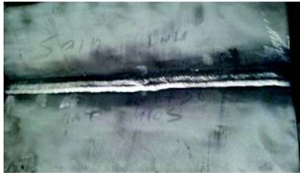
Fig. 2.11. Cordón de soldadura del acero inoxidable ferrítico 410S.
