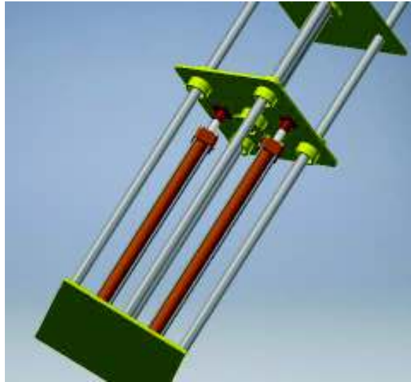
Figura 2.33. Módulo 3, cilindros hidráulicos. (Fuente: Elaboración Propia)
