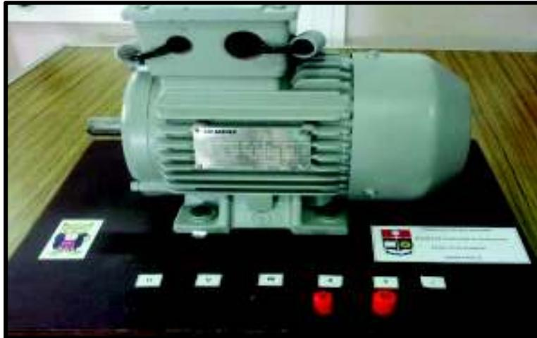
**Figura 2.2** Módulo del motor trifásico
