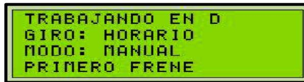
**Figura 2.26** Mensaje de restricción al invertir el giro en funcionamiento manual
