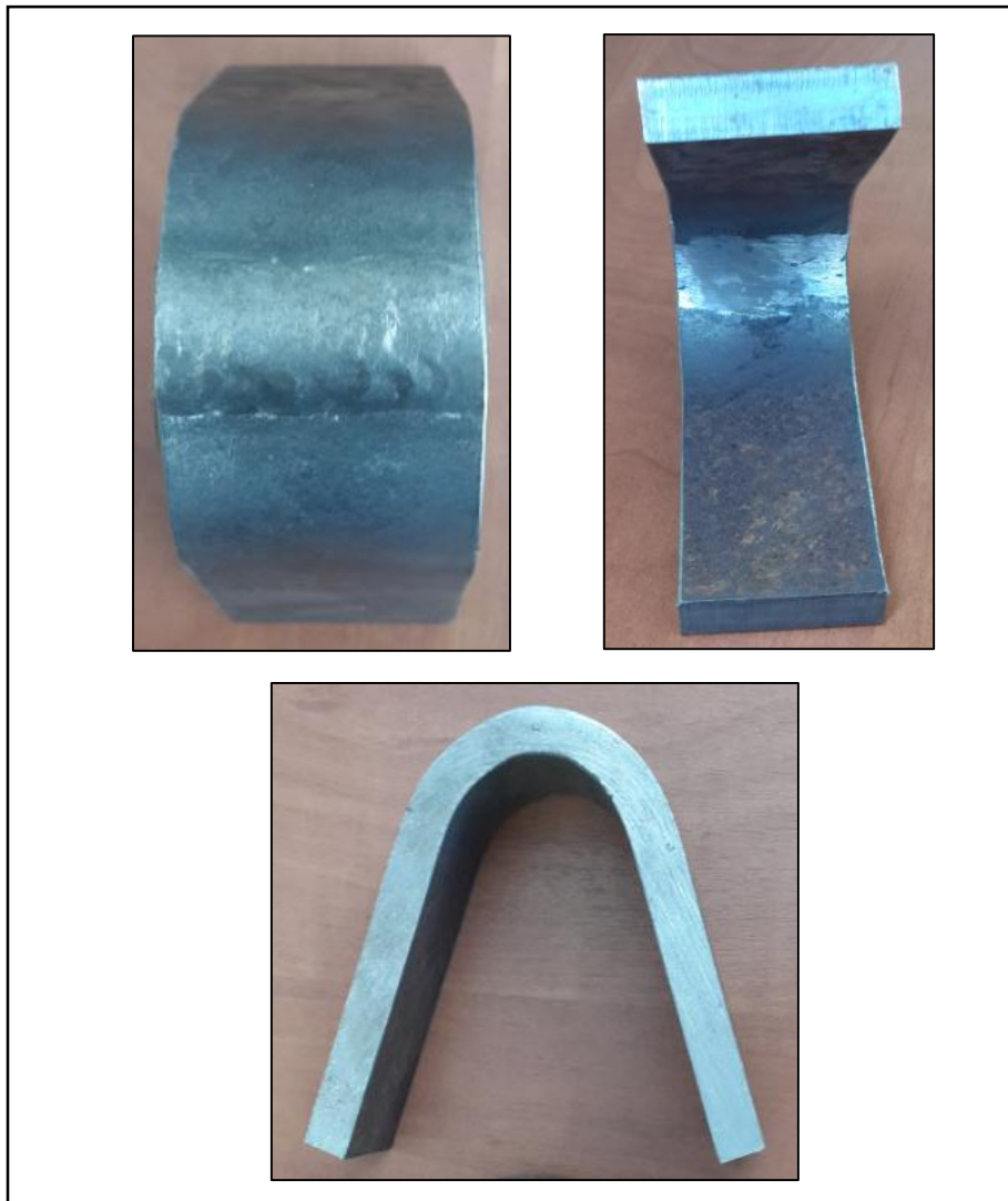
Figura 4. 45. Doblado de cara de la unión Octógono - Octógono. (Fuente: Laboratorio de ensayos no destructivos)
