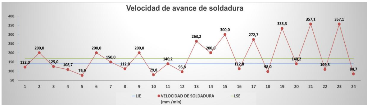
Figura 3. 22. Representación de la velocidad de avance de soldadura. (Fuente: Análisis estadístico de las pruebas de soldadura)
