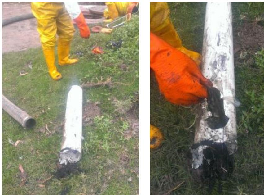
**FIGURA 3.18 ROTURA DE TUBERÍA A LA SALIDA DE LA FOSA SÉPTICA**
