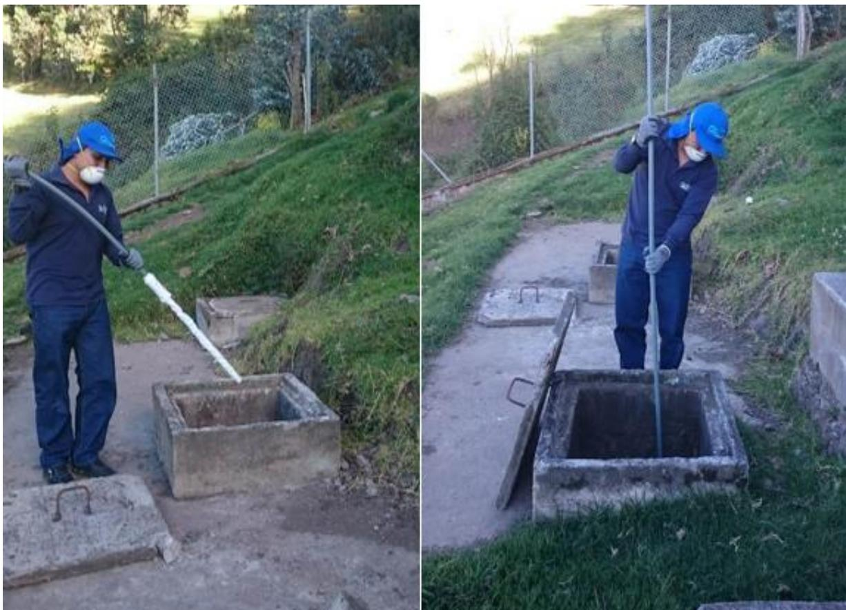
**FIGURA 4.5 MEDICIÓN DE NIVEL DE LODOS**
