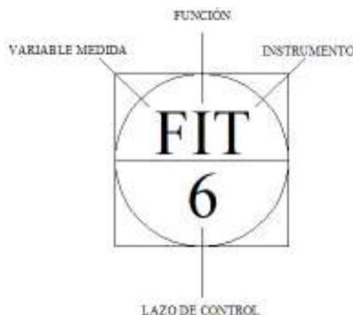
**Figura 4.33.** Códigos de identificación de instrumentos para diagramas P&ID
