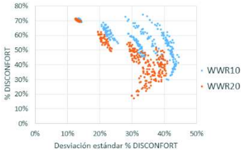
Gráfico 3.10. Efecto del acristalamiento sobre el disconfort para edificios con porcentaje de acristalamiento: al 10% y 20%.
