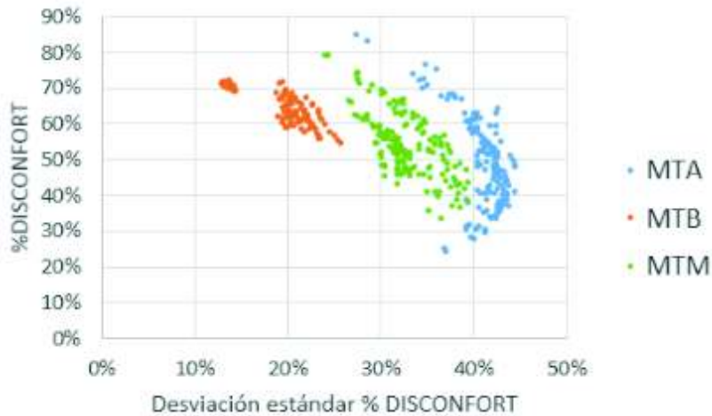
Gráfico 3.22. Efecto de la masa térmica sobre el discomfort para edificios con masa térmica: baja, media y alta.
