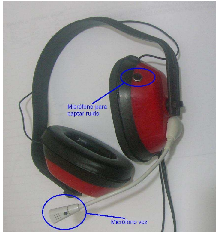
Figura 5.11 Posición de los micrófonos en las orejeras
