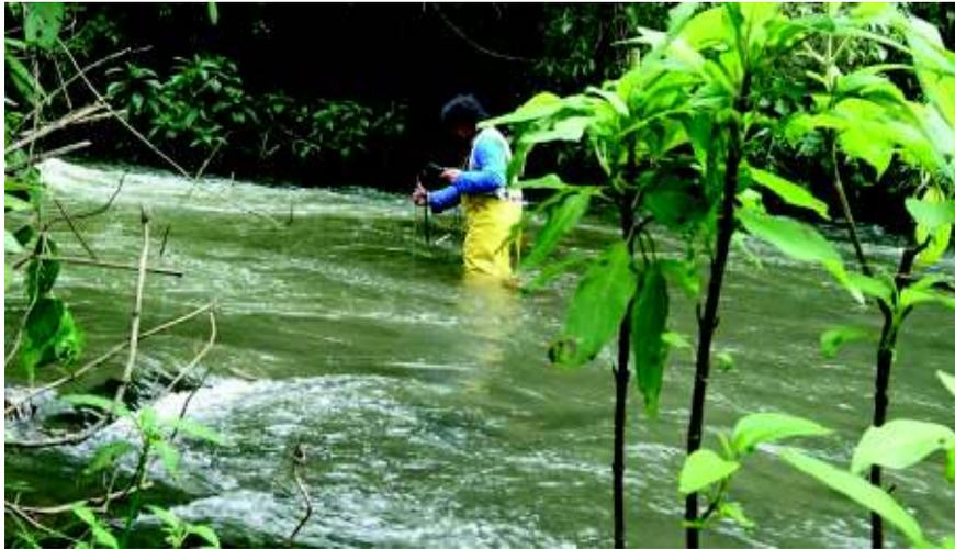
**Figura 28.** Toma medidas de velocidad con mini molinete
