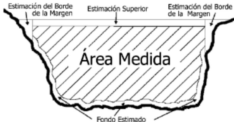
**Figura 24.** Áreas transversales no medidas por el ADCP
