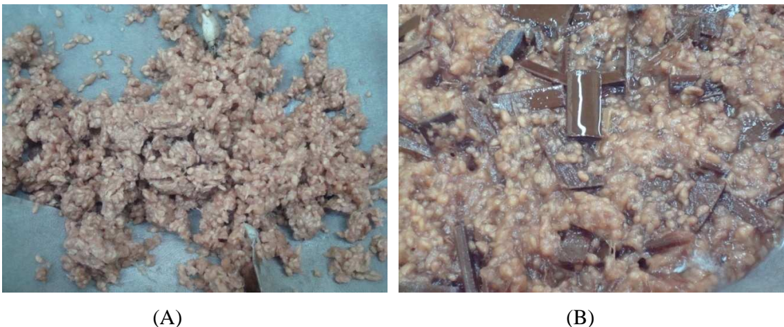
Figura 3.3: Pulpas antes del batido: A.- Proceso a la Sosa, B.- Proceso al Sulfito
