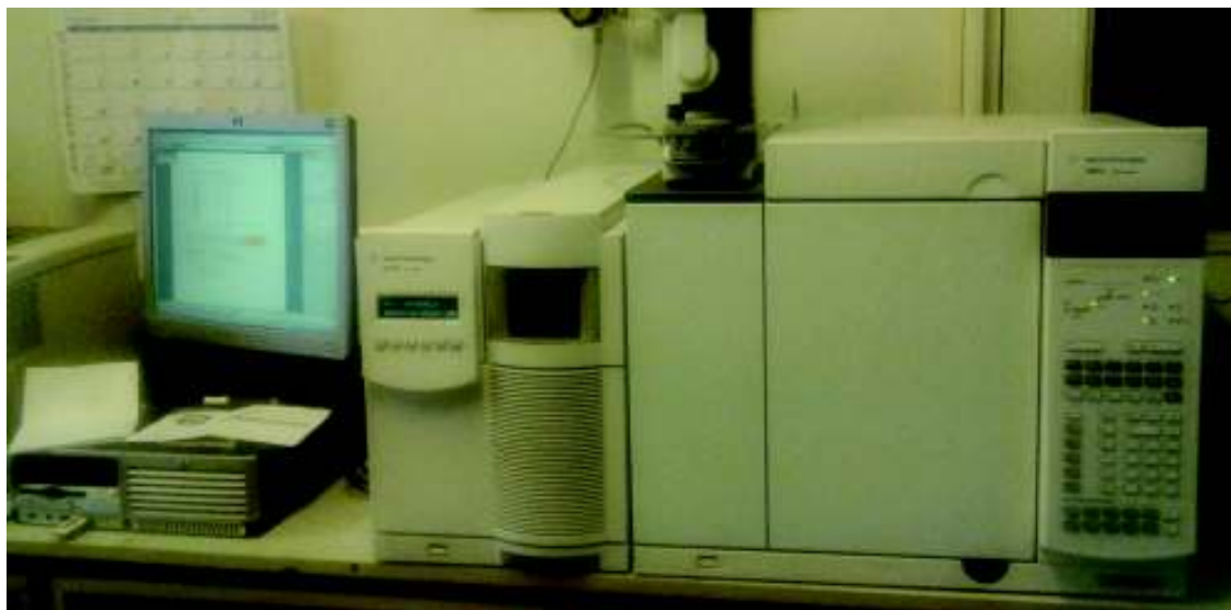
FIGURA 21 INYECCIÓN DEL GLIFOSATO EN EL CROMATÓGRAFO DE GASES
