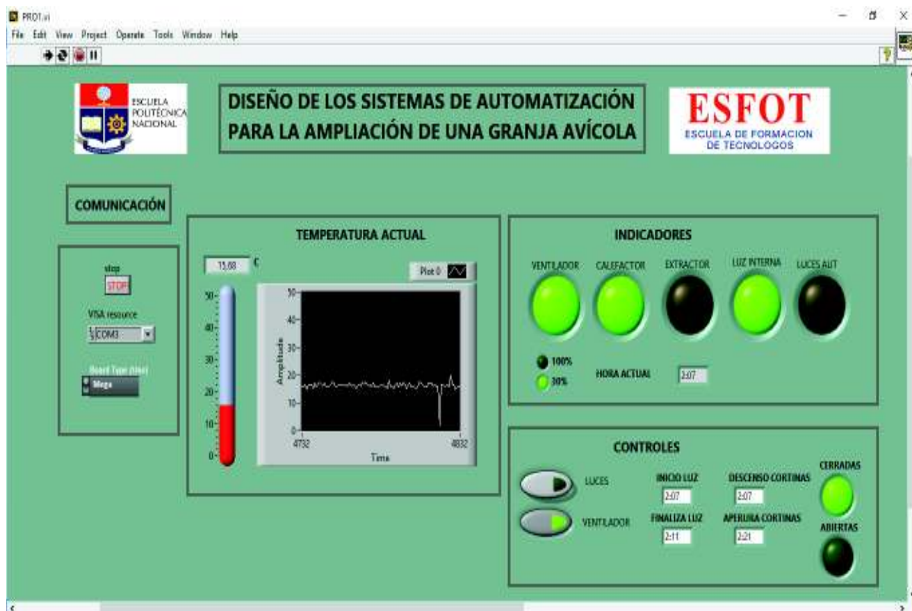
Figura 66. Funcionamiento del sistema automático de apertura y cierre. Fuente: Propia
