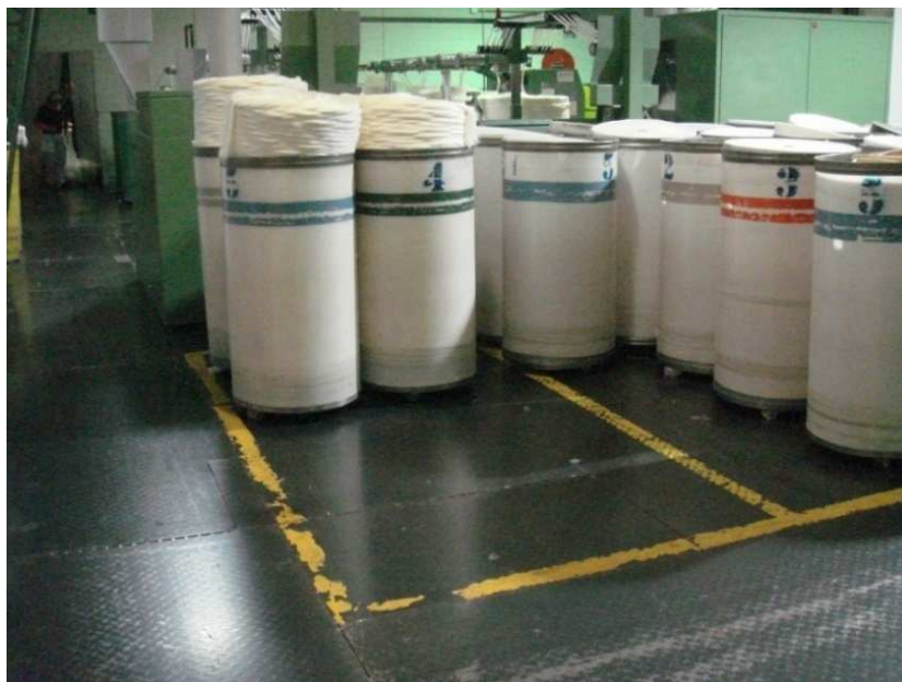
Figura 4.5.- Delimitación en mal estado
