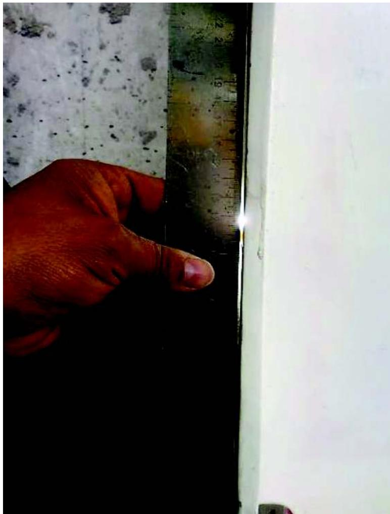
**Figura 3-110.-** Deformación plástica en patín inferior de la viga en la zona de la sección reducida Probeta 5 cortesía (Ing. Hugo Pillajo)
