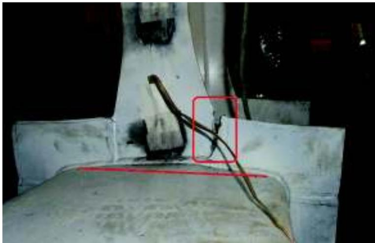
**Figura 3-55.-** Falla en ciclo 7.2 Probeta 3
