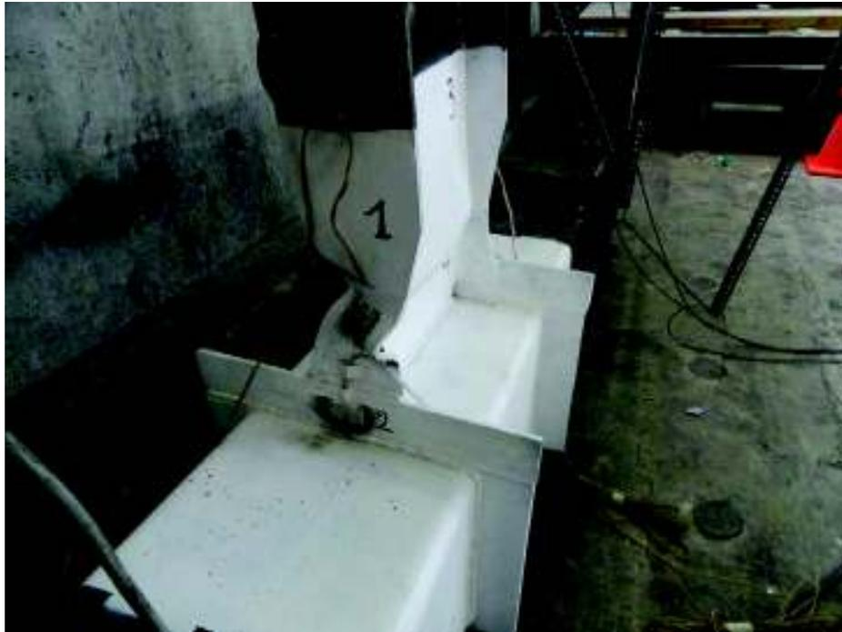
**Figura 3-91.-** Falla en ciclo 10.1 Probeta 4
