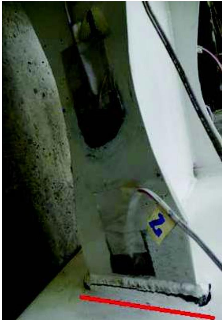
**Figura 3-106.-** Falla de material base en zona de soldadura de patín inferior de viga a una rotación de 0.05 (rad) Probeta 5 cortesía (Ing. Hugo Pillajo)
