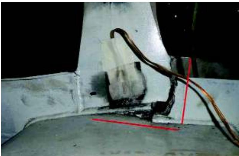
**Figura 3-62.-** Falla en ciclo 9.2 Probeta 3
