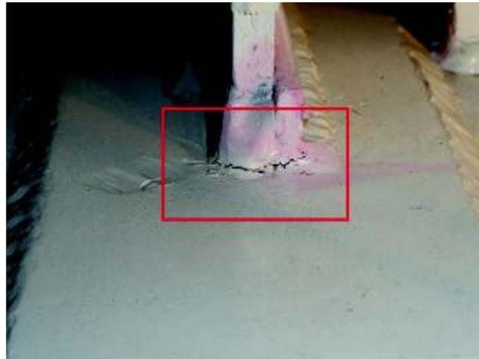
**Figura 3-26.-** Falla en ciclo 6.1 Probeta 2
