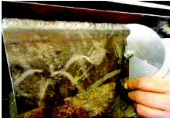
**Figura 2-19.-** Inspección visual del cordón entre la diagonal y el canal de la columnas para probetas del modelo 1 y modelo 4
