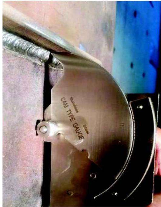
**Figura 2-27.-** Medición del filete en la soldadura de la placa de respaldo y la columna. Posición 4G
