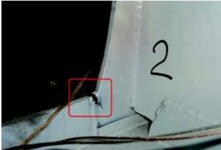
**Figura 3-54.-** Falla en ciclo 7.1 Probeta 3
