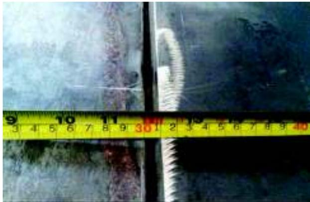
**Figura 2-16.-** Abertura de la raíz para la soldadura CJP en la longitud L de la conexión
