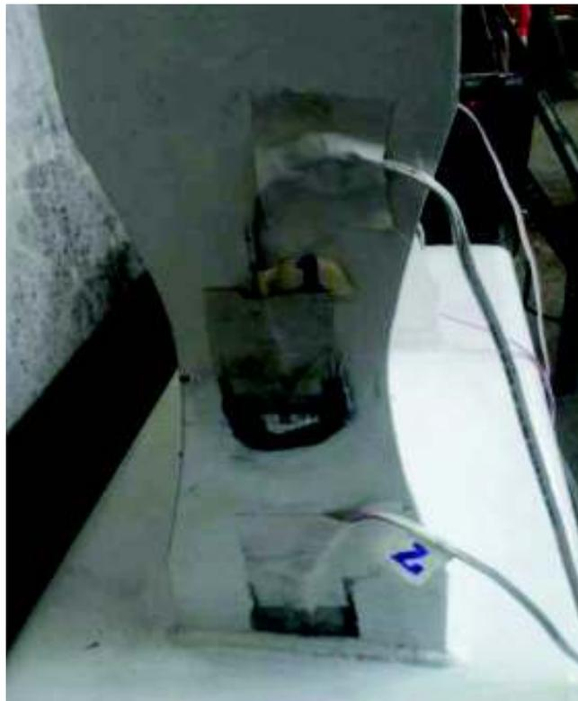
**Figura 3-112.-** Enumeración de Straing Gauges Patín Inferior Probeta 5 cortesía (Ing. Hugo Pillajo)
