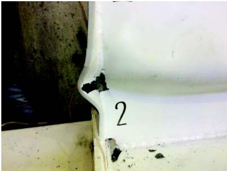
**Figura 3-94.-** Falla en ciclo 10.1 Probeta 4
