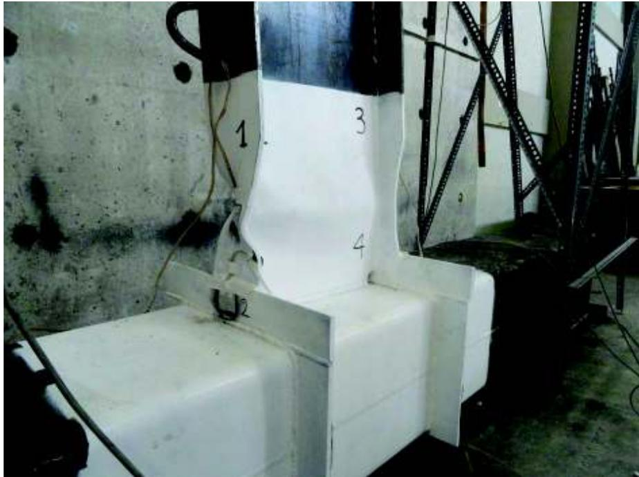
**Figura 3-85.-** Falla en ciclo 9.1 Probeta 4
