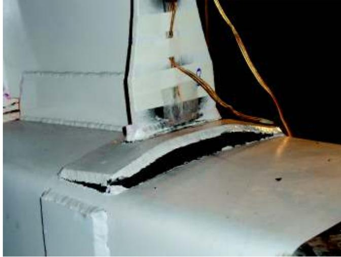
**Figura 3-36.-** Falla en ciclo 9.2 Probeta 2
