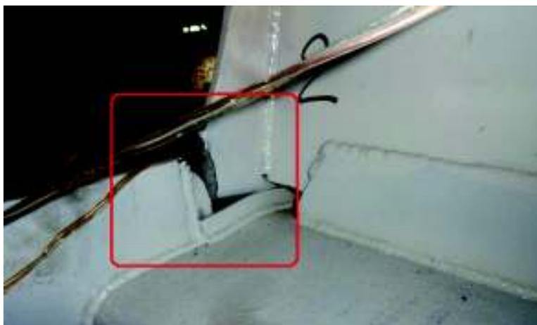
**Figura 3-59.-** Falla en ciclo 8.2 Probeta 3
