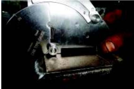
**Figura 2-24.-** Ángulo de canal del patín superior de la viga
