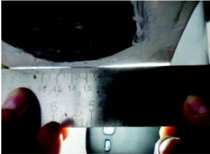
**Figura 3-111.-** Deformación plástica en patín inferior de la viga en la zona de la sección reducida vista en planta Probeta 5 cortesía (Ing. Hugo Pillajo)
