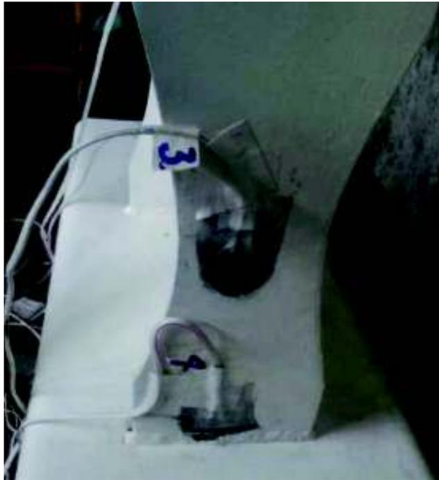
**Figura 3-113.-** Enumeración de Straing Gauges Patín Superior Probeta 5 cortesía (Ing. Hugo Pillajo)
