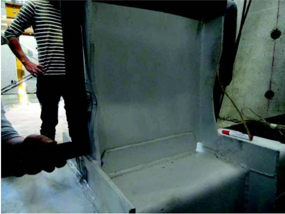
**Figura 3-79.-** Falla en ciclo 8.1 Probeta 4
