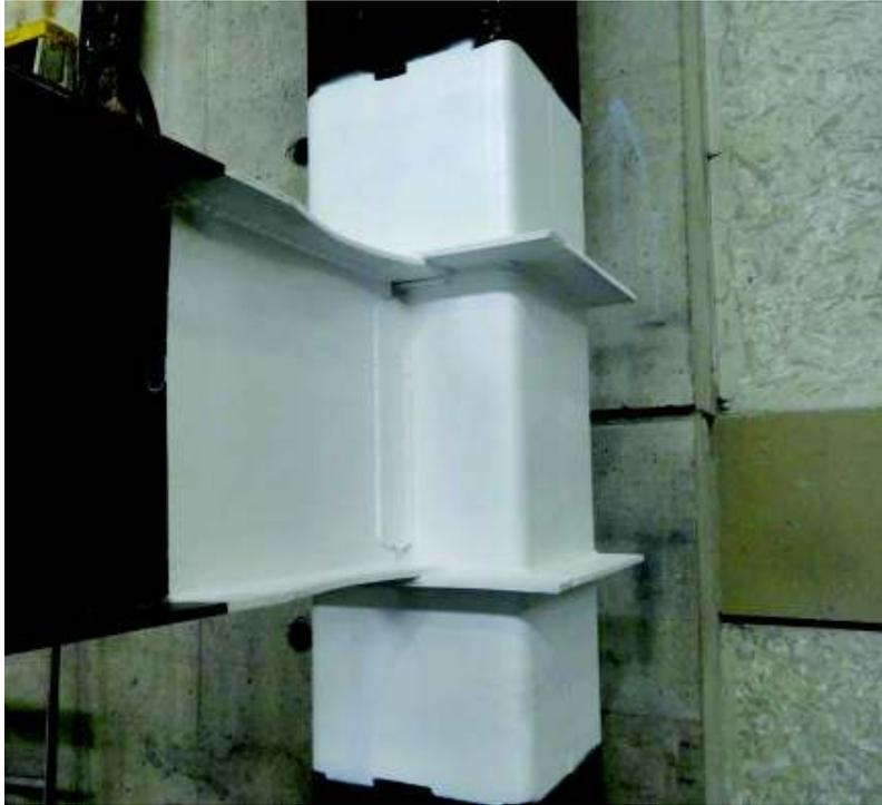
**Figura 2-35.-** Vista frontal conexión viga de sección reducida-columna con anillo de placas colocadas alrededor de la columna compuesta RCFT de manera perpendicular a la cara de la columna con diagonales internas perteneciente a la Probeta 4, se puede apreciar como las placas de refuerzo están colocadas encima del patín superior y debajo del patín inferior
