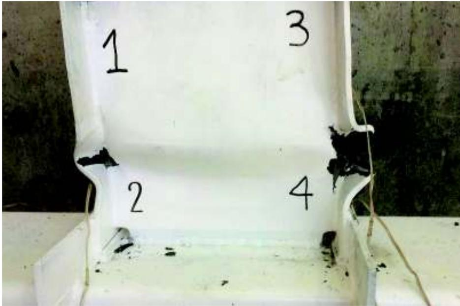
**Figura 3-95.-** Falla en ciclo 10.2 Probeta 4
