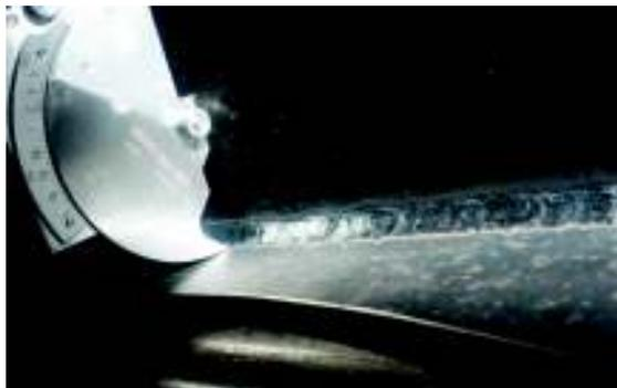
**Figura 2-26.-** Medición del filete en zona protegida de la viga
