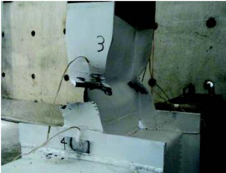
**Figura 3-96.-** Falla en ciclo 10.2 Probeta 4
