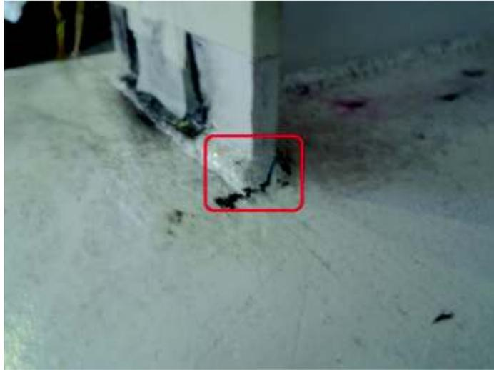
**Figura 3-3.-** Falla en ciclo 6.1 Probeta 1
