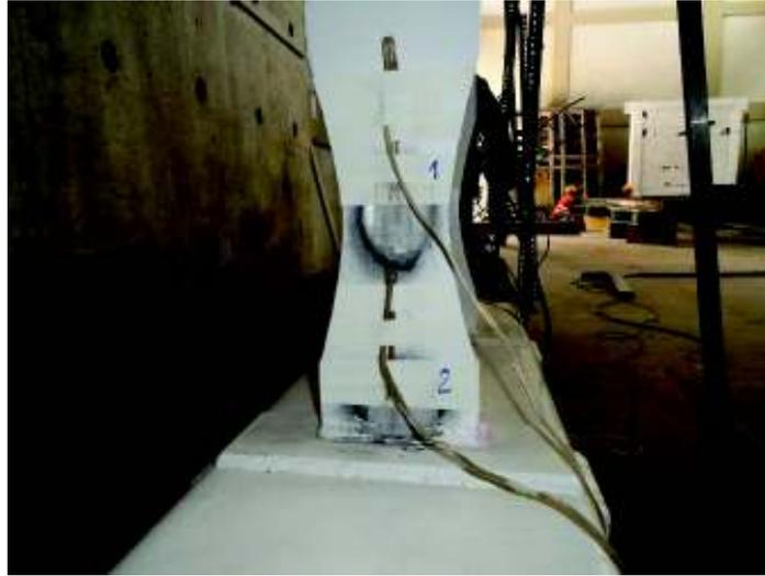
**Figura 3-40.-** Enumeración de Straing Gauges Patín Superior Probeta 2
