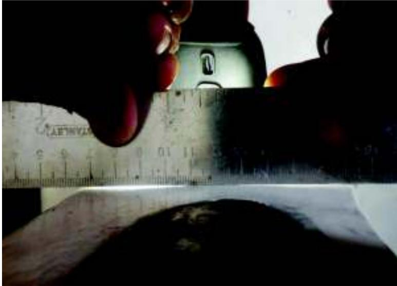
**Figura 3-109.-** Deformación plástica en patín superior de la viga en la zona de la sección reducida vista en planta Probeta 5 cortesía (Ing. Hugo Pillajo)
