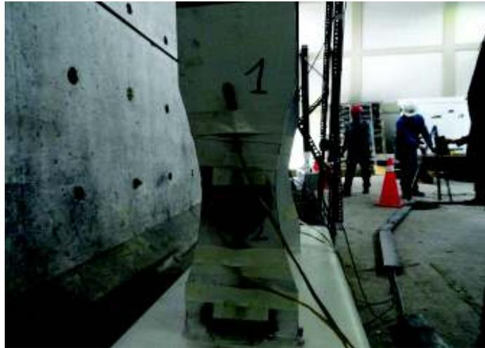
**Figura 3-15.-** Enumeración de Straing Gauges Patín Superior Probeta 1
