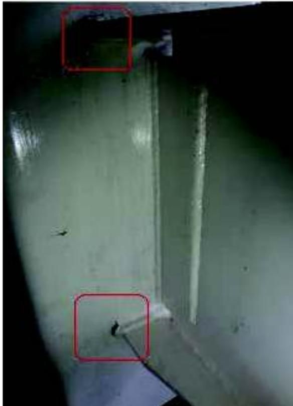
**Figura 3-107.-** Falla de material base en esquinas de patín superior e inferior de la viga a una rotación de 0.05 (rad) Probeta 5 cortesía (Ing. Hugo Pillajo)
