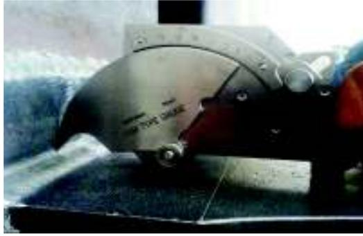
**Figura 2-31.-** Medición del refuerzo colocado en el patín superior de la viga
