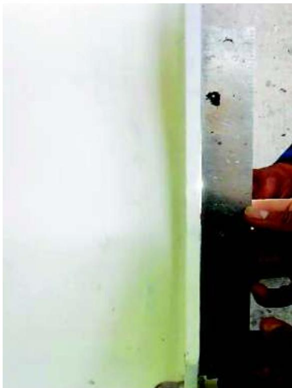
**Figura 3-108.-** Deformación plástica en patín superior de la viga en la zona de la sección reducida Probeta 5 cortesía (Ing. Hugo Pillajo)
