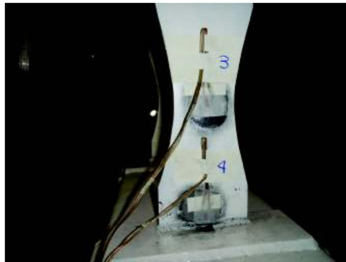
**Figura 3-41.-** Enumeración de Straing Gauges Patín Inferior Probeta 2
