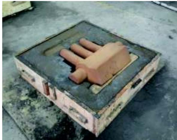
Figura 2.57. Noyos de la carcasa montados en el molde inferior
