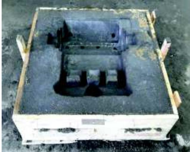
Figura 2.55. Moldeo de la carcasa (molde superior)
