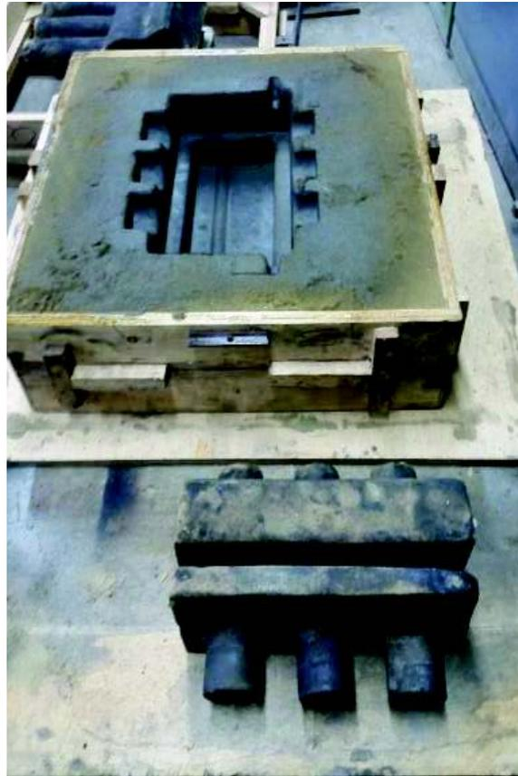
Figura 2.56. Molde inferior y noyo del separador
