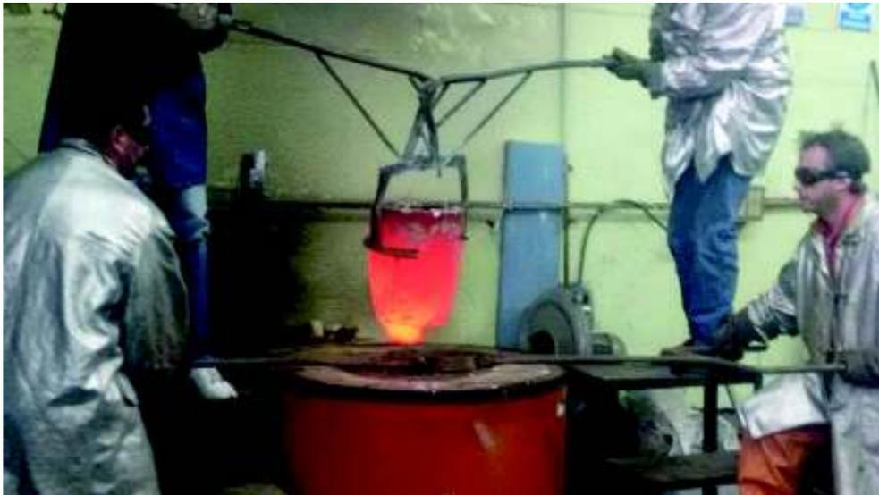
Figura 2.63. Extracción de la colada de aluminio del horno.
