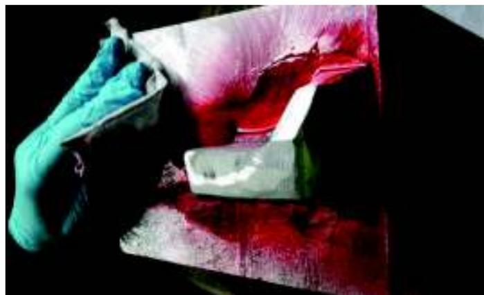
Figura 3.14. Líquido penetrante en base de sujeción de separador.
