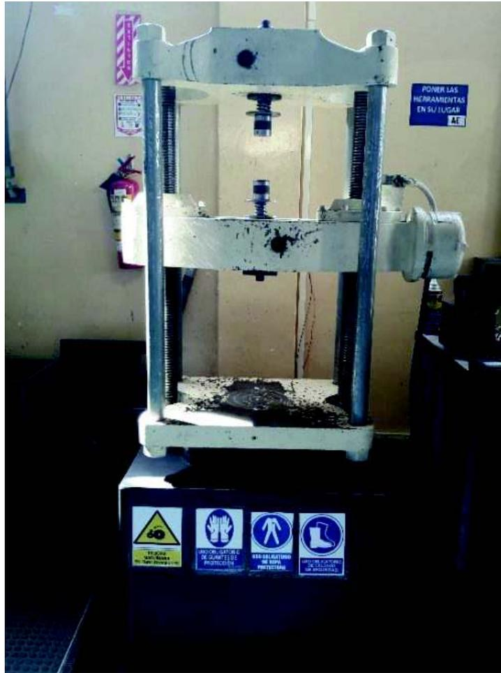
Figura 3.6. Máquina de ensayos universal del Laboratorio
