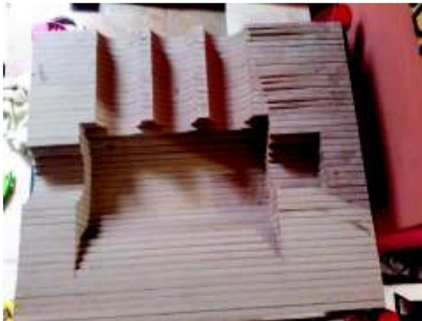
Figura 2.46. Proceso de obtención de cajas de noyos por manufactura de capas
