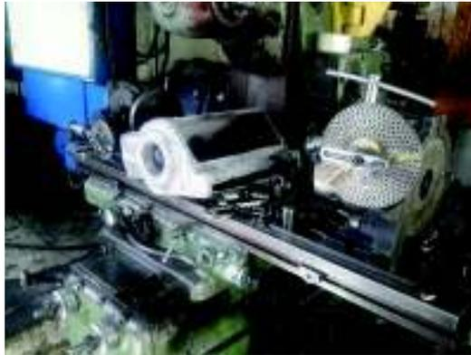
Figura 3.1. Maquinado de la Carcasa.
