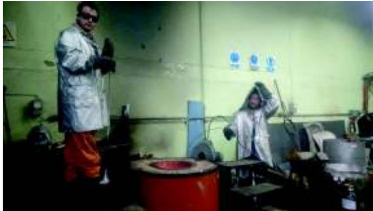
Figura 2.62. Proceso de preparación de la colada de aluminio.
