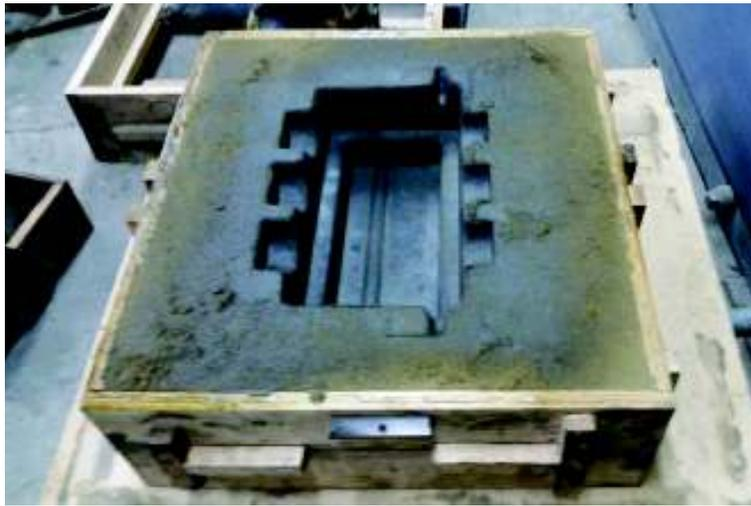
Figura 2.53. Moldeo del Separador (molde inferior)
