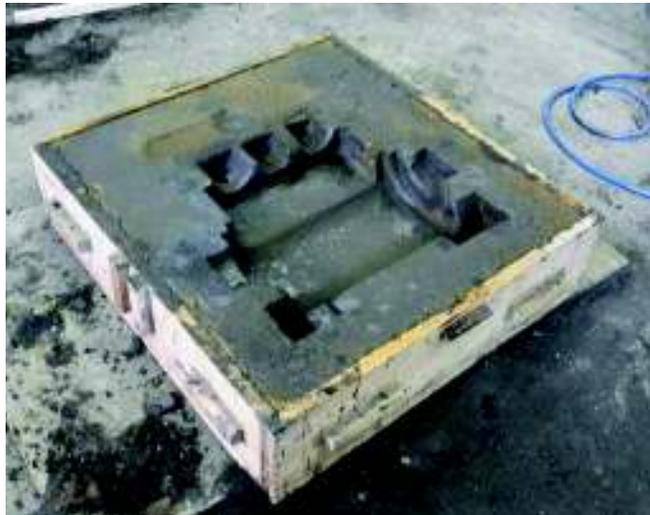
Figura 2.54. Moldeo de la carcasa (molde inferior)
