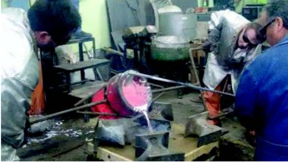
Figura 2.64. Colado del material fundido en el molde.
