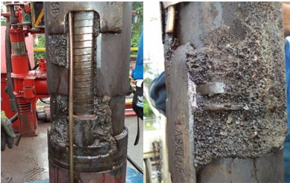
Fotografías evidenciando el escalamiento en equipo BES, Pozo SSF-119D.
