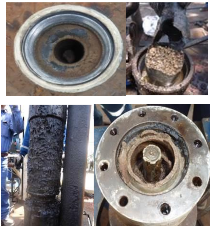
Fotografías evidenciando el escalamiento en equipo BES, Pozo SSF-119D.
