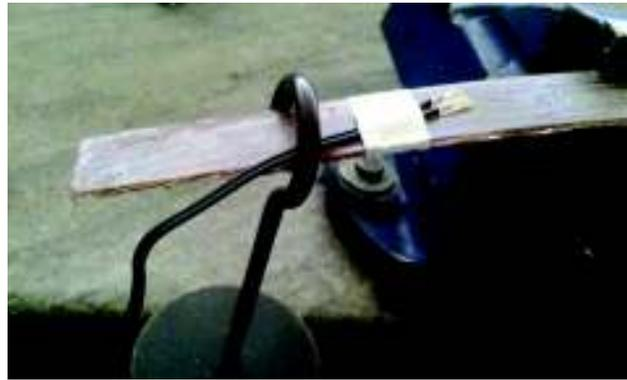
Figura 2.42. Probeta de material compuesto deformada con peso de 0,5 kg.
