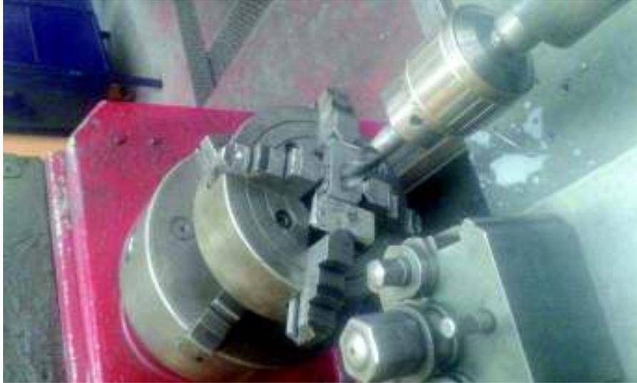
Figura B- 11 Posicionamiento de cuñas en Torno
