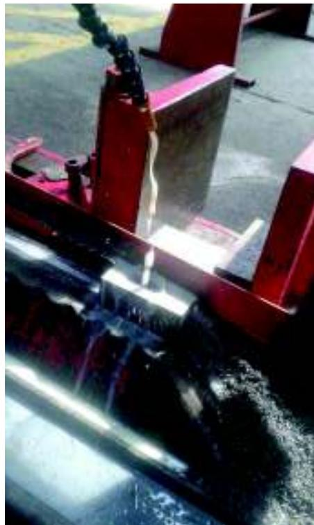
Figura B-4 Seccionamiento de las 4 cuñas
