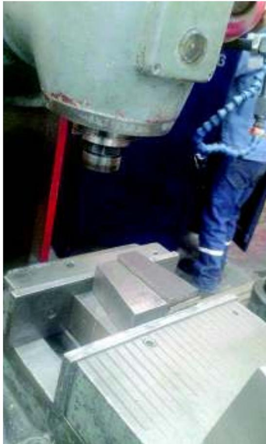
Figura B-8 Posicionamiento de las cuñas en la fresa
