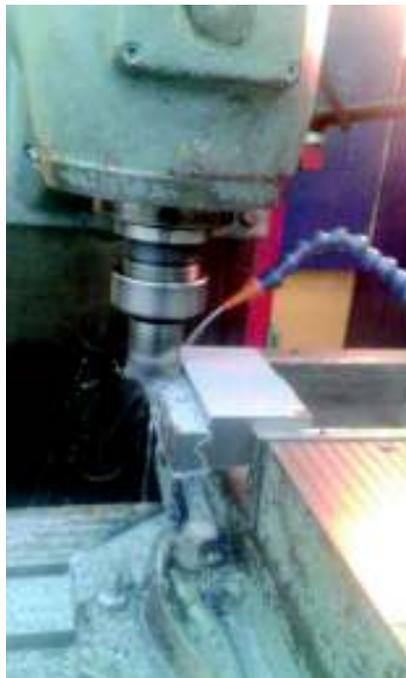
Figura B-10 Fresado de canal
