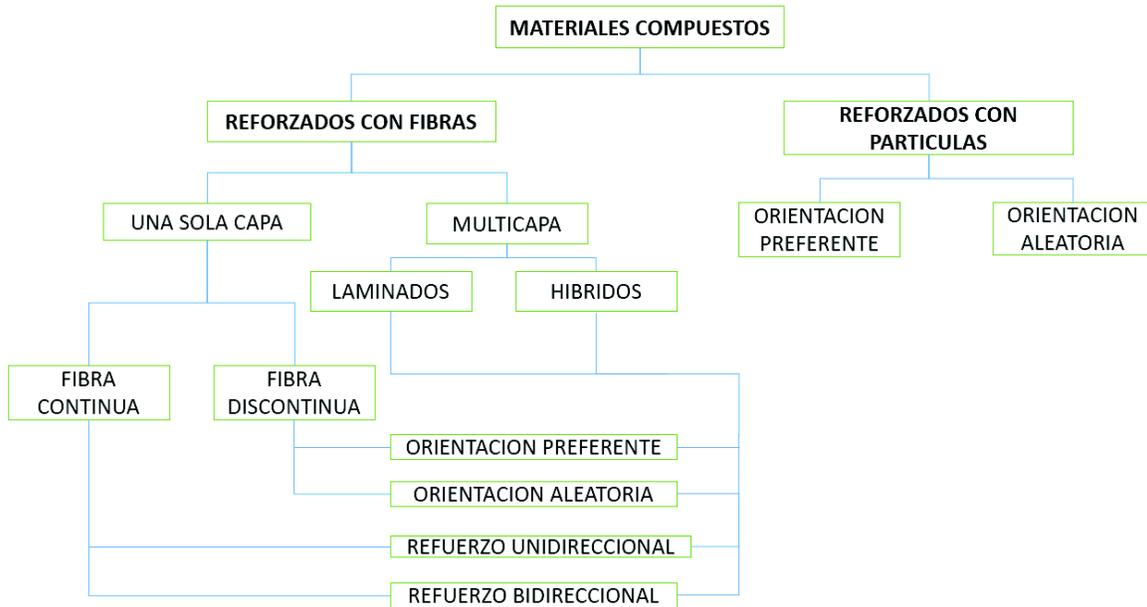
Figura 1.1. Clasificación de los materiales compuestos.
