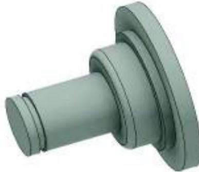
Figura 2.13. Modelo del eje de sujeción de la probeta.
