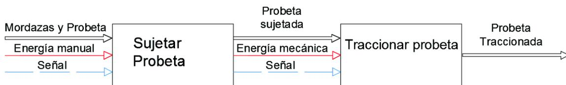
Figura 2.2. Diagrama funcional nivel 1.
