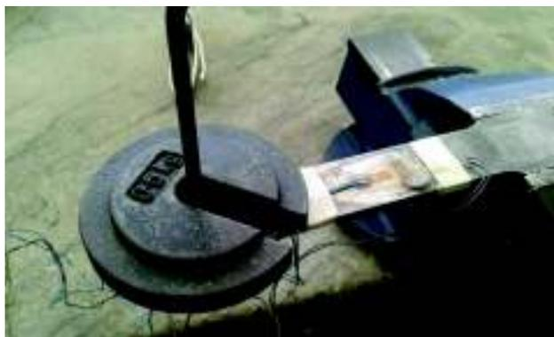
Figura 2.40. Calibración con probeta de acero y peso de 0,5 kg.
