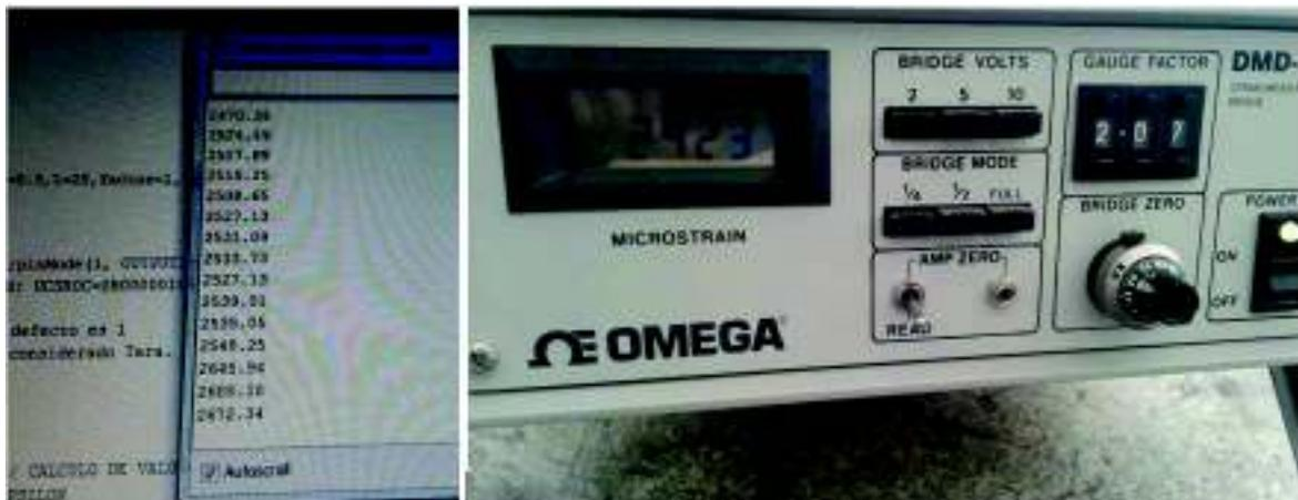
Figura 2.43. Mediciones con arduino y medidor OMEGA para probeta 2.
