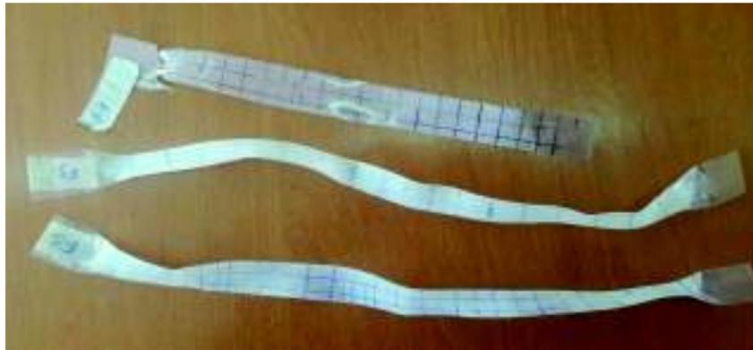
Figura 3.3. Probetas de acetato ensayadas con mordazas off-axis.
