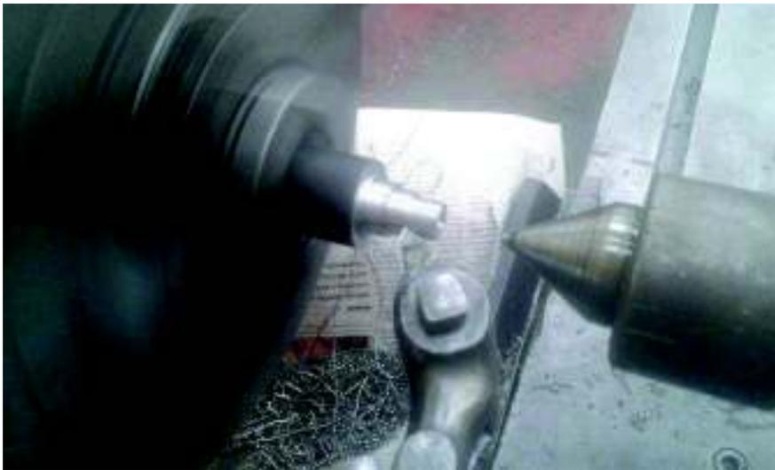
Figura B-14 Torneado del eje
