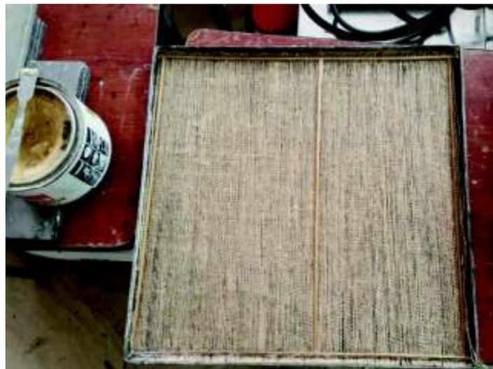
Figura 2.34. Colocación de la fibra dentro del molde.
