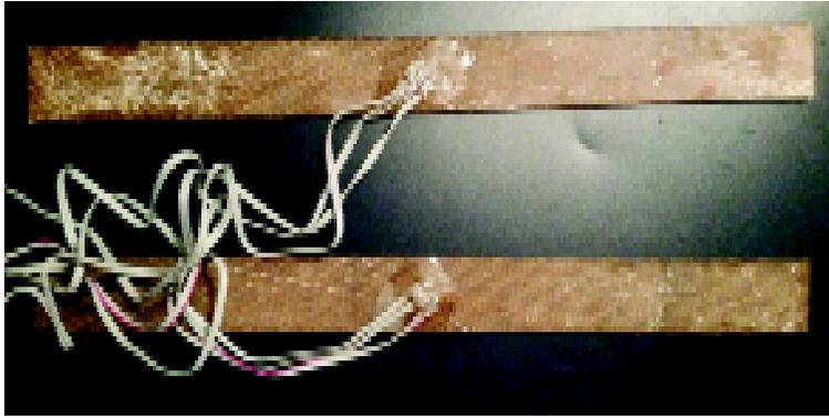
Figura 2.38. Probetas con galgas tipo roseta para ensayos de tracción.
