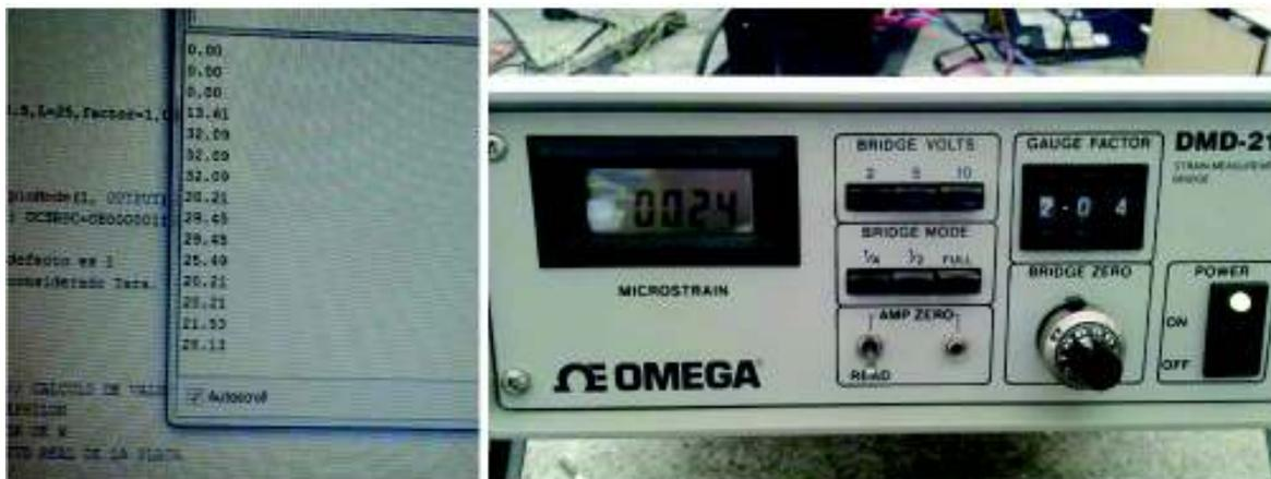
Figura 2.41. Mediciones de deformación con arduino y medidor OMEGA.
