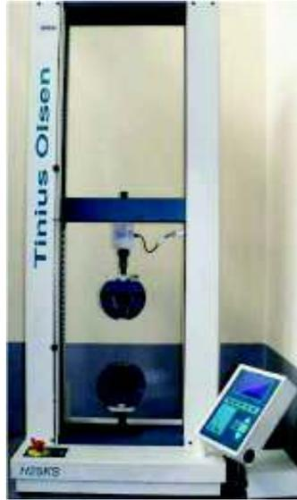
Figura 1.32. Maquina universal de ensayos Tinius Olsen.
