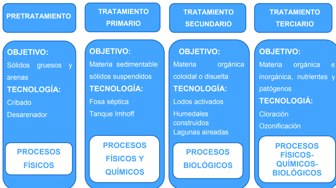
FIGURA 2.1 PROCESOS UNITARIOS INVOLUCRADOS EN LOS SISTEMAS DE TRATAMIENTO DE AGUAS RESIDUALES
