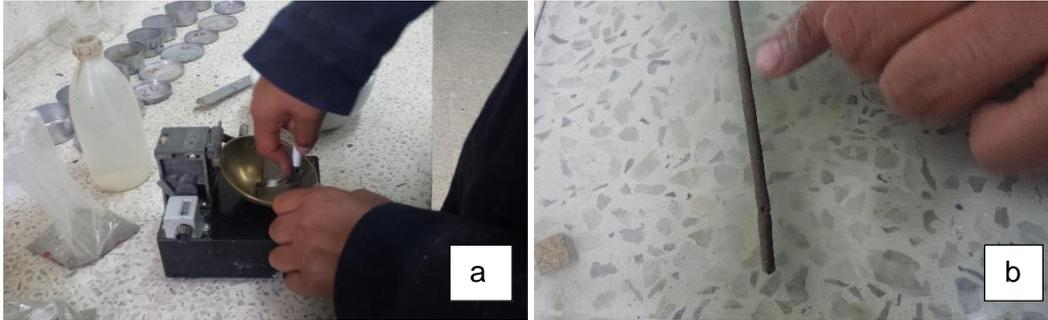
**Fotografía 4.2** Ensayo de Límites de Atterberg. a) Índice líquido, b) Índice plástico.
