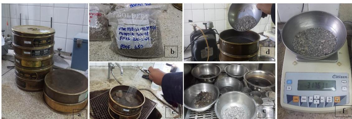
**Fotografía 4.1** a) Tamices # 4, 10, 20, 40 y 200, b) muestra alterada, c) lavado de la muestra para separar los finos inferiores al tamiz #200, d) tamizado, e) secado de las muestras, f) toma de datos con la muestra seca.
