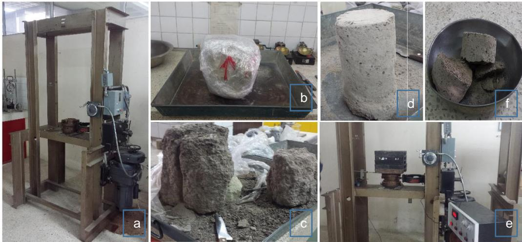
**Fotografía 4.4** a) Instrumentación utilizada en el ensayo de corte directo, b) – d) preparación de la muestra, e) toma de datos, f) muestra fallada.
