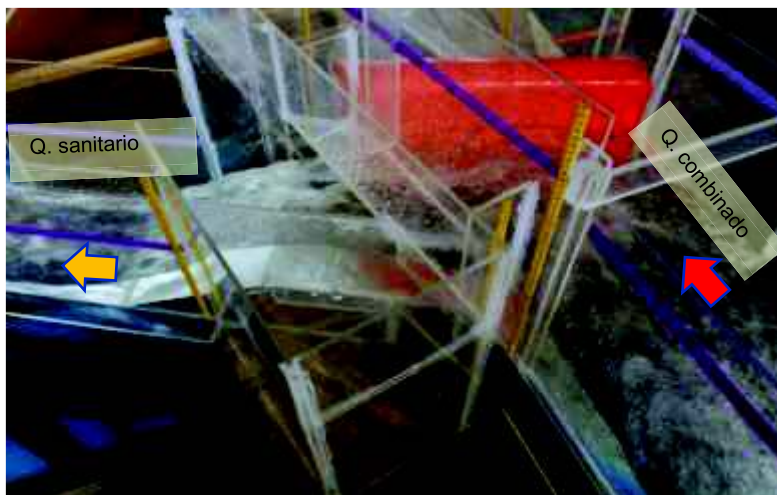
Fotografía 6-11: Prueba C-2. Vista superior del comportamiento del flujo.
