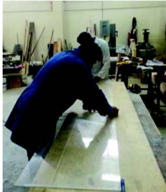
Fotografía 3-7: Corte, pegado, secado y control de las piezas de acrílico que componen los colectores del modelo del separador de caudales.
