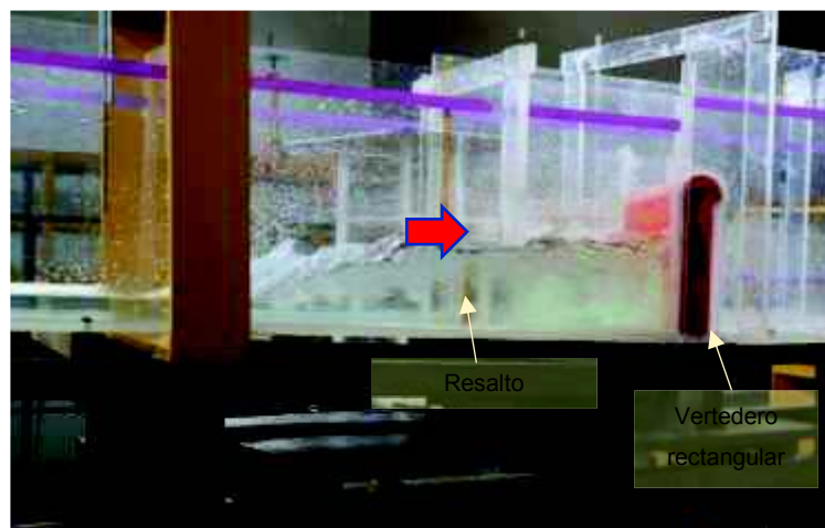
Fotografía 6-12: Prueba C-2. Vista lateral derecha, resalto hidráulico y vertedero de cresta semicircular.
