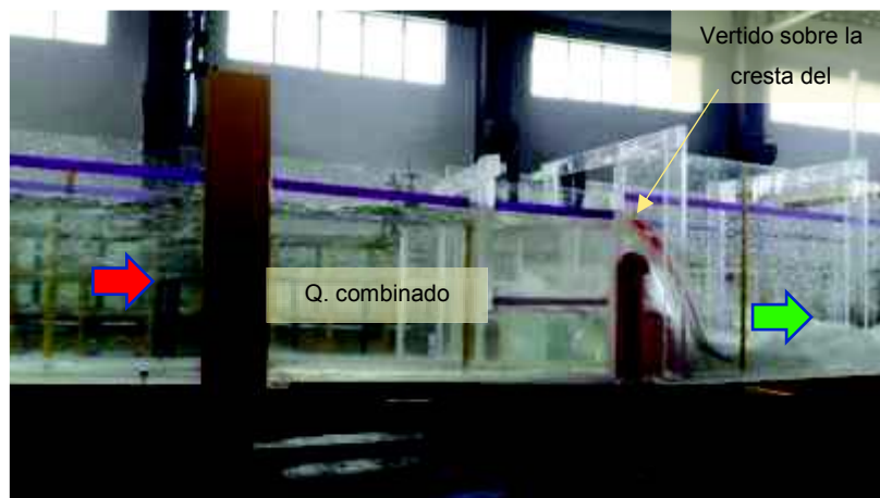
Fotografía 6-7: Prueba B-3 Vista lateral derecha. Umbral de direccionamiento y vertido hacia el canal pluvial.
