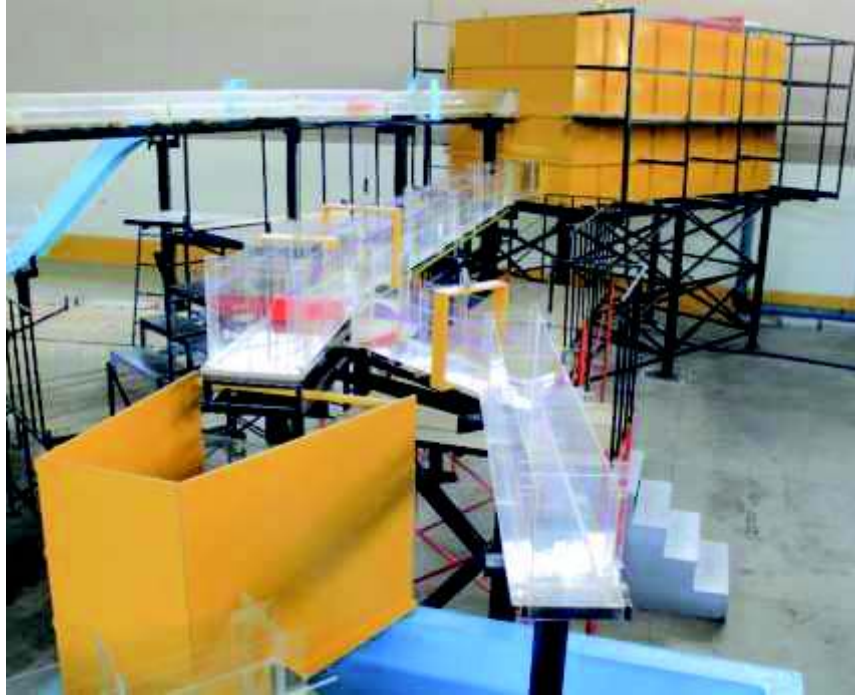
Figura 3-12: Esquema 3D del modelo físico de separado de caudales
