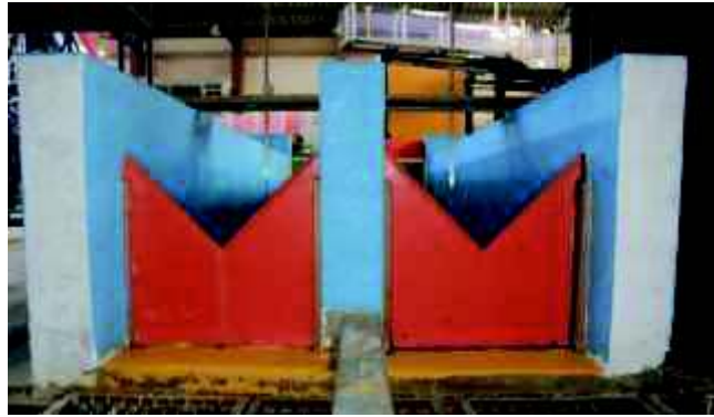
Fotografía 3-17: Aforo para determinación de la curva experimental de descarga.
