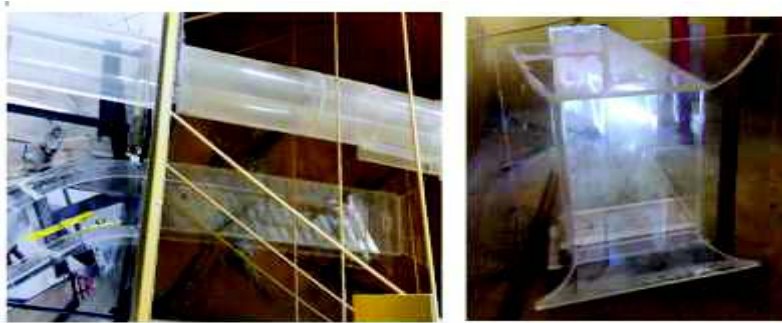
Fotografía 3-12: Montaje del canal de aproximación.
