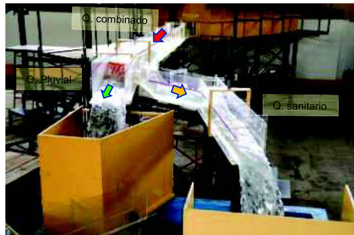
Fotografía 6-21: Prueba C5. Vista frontal. Comportamiento del flujo en el separador de caudales PE36A
