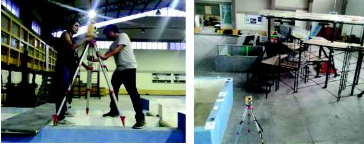
Fotografía 3-9: Replanteo de puntos y trazado de ejes para la implantación del modelo físico.
