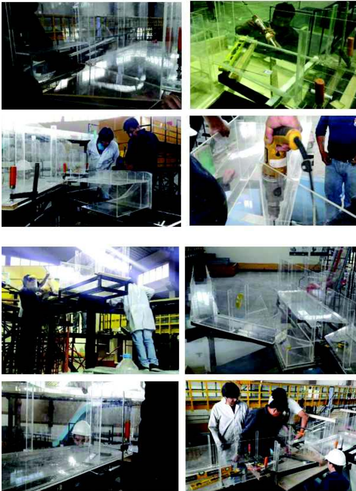
Fotografía 3-14: Montaje de los colectores pluvial y sanitario y ubicación de las estructuras adicionales del separador de caudales.
