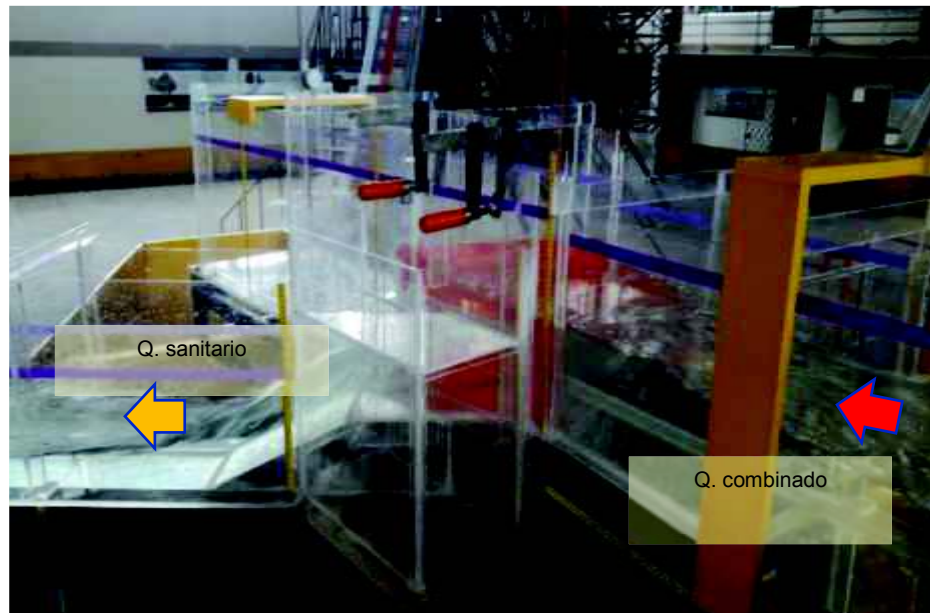
Fotografía 6-1: Prueba B-1 Vista lateral Izquierda zona de separación
