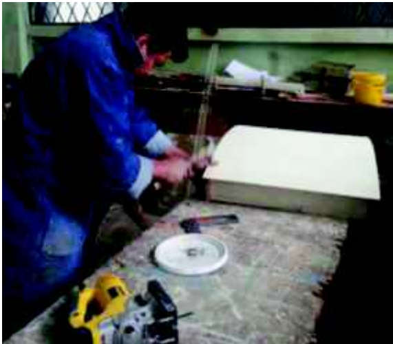
Fotografía 3-8: Calentamiento moldeado y prensa de las piezas que componen las secciones curvas del modelo de separador de caudales.
