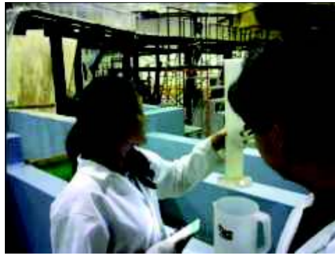
Fotografía 3-17: Aforo para determinación de la curva experimental de descarga.
