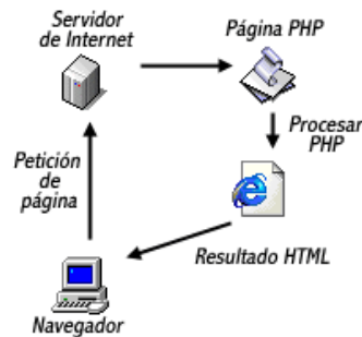
Figura 3.5.- Diagrama ejecución del intérprete PHP
