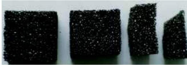
Figura 4.2: Fragmentos de la esponja de PU-G, demostrando que por cualquier sección se tiene una distribución igual de láminas de grafeno
