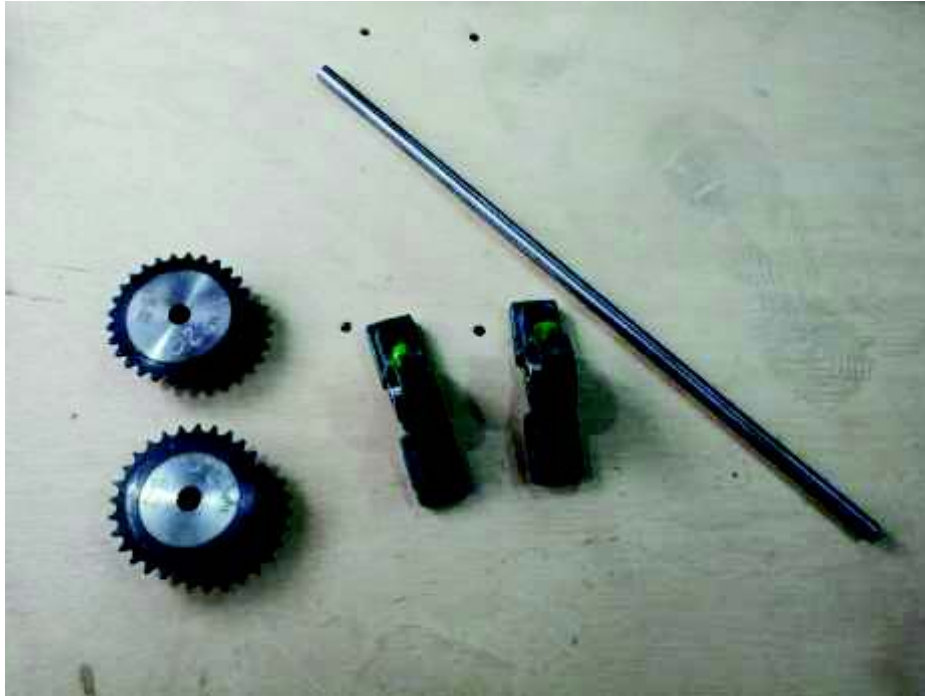
Figura 3.16. Eje final desarmado. (Fuente: Propia)
