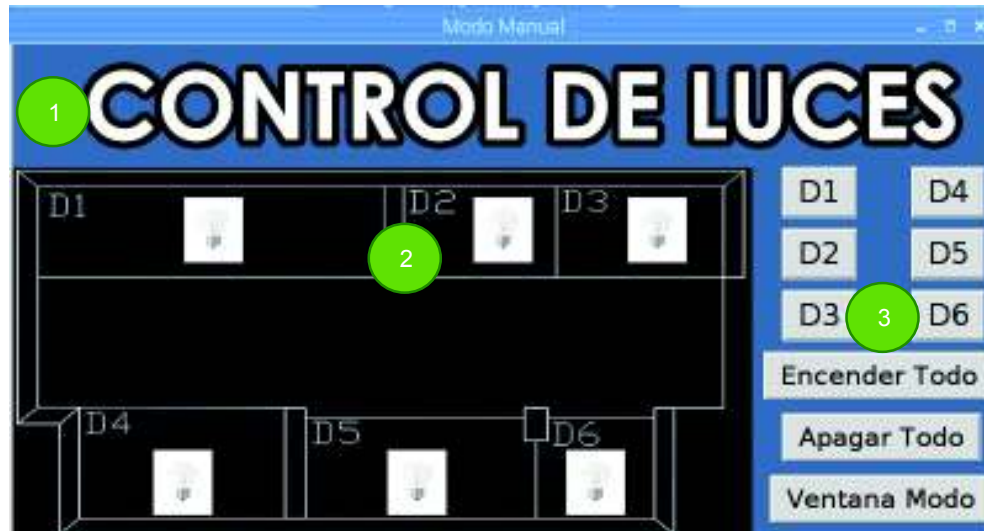
Figura 3.28 Ventana modo manual sistema de iluminación
