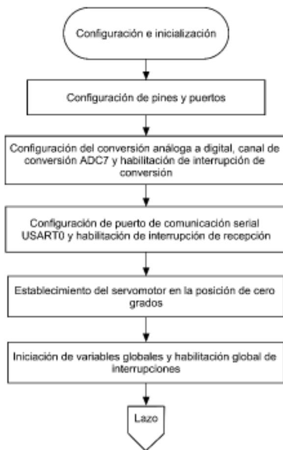
Figura 3.42 Diagrama de flujo de la Configuración e inicialización
