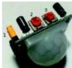
Figura 2.6 Elementos configurables del Sensor PIR HC-SR501 [37]
