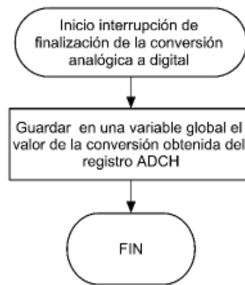
Figura 3.45 Diagrama de flujo de la rutina de interrupción de finalización de conversión A/D
