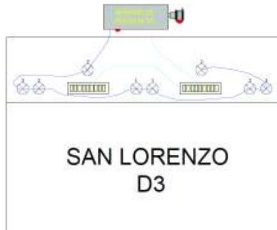
Figura 4.12 Distribución de luminarias en el diorama 3
