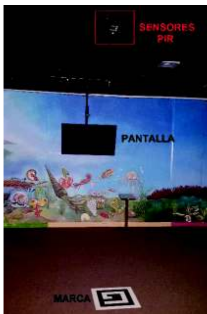
Figura 2.29 Disposición de la pantalla, marca y sensores PIR
