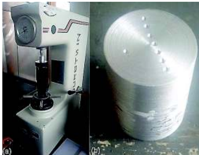
Figura 2.22. Ensayo de dureza, (a) medidor de dureza Rockwell, (b) muestra después del ensayo de dureza. (Fuente: Propia)
