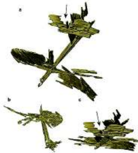
Figura 1.13. Reconstrucción 3D de un grupo de plaquetas \beta - Al_5FeSi mostrada en tres orientaciones. (Fuente: [53])
