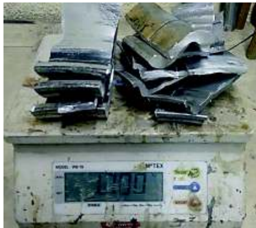
Figura 2.7. Carga de material para el molde de arena. (Fuente: Propia)
