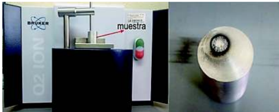
Figura 2.28. Espectrómetro de chispa BRUKER modelo Q2 ION. (Fuente: Propia)
