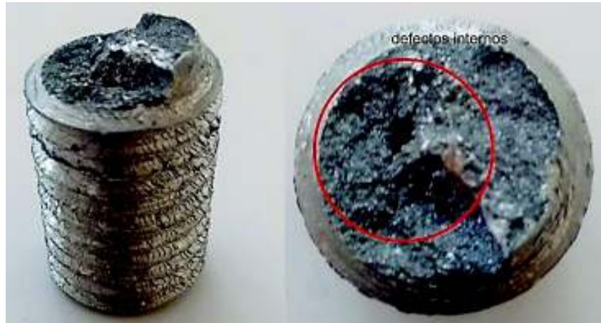
Figura 2.4. Defectos internos en la rosca inferior de las probetas ensayadas por tracción. (Fuente: Propia)
