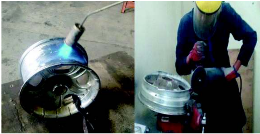
Figura 2.6 Corte y limpieza de aros de aleación A 356. (Fuente: Propia)
