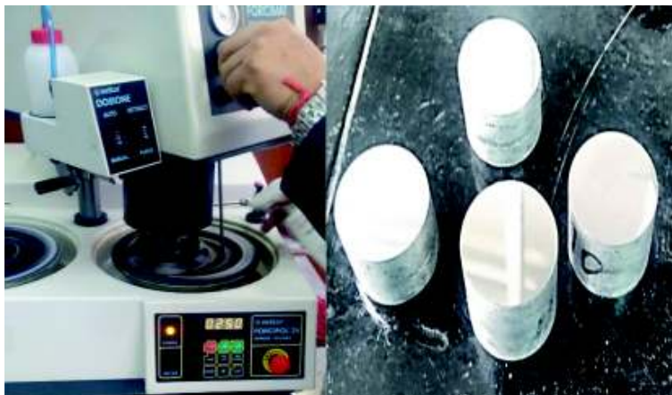
Figura 2.33. Proceso de pulido de las muestras, utilizando lubricantes y abrasivos disueltos. (Fuente: Propia)
