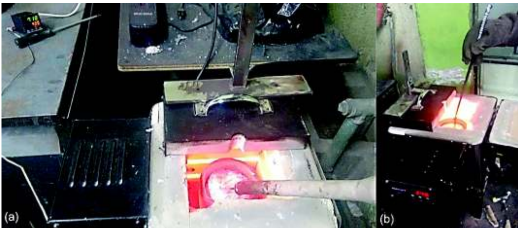
Figura 2.12. Proceso de adición de la aleación maestra de Al-Fe, (a) control de temperatura, (b) adición y mezcla del contaminante de hierro. (Fuente: Propia)
