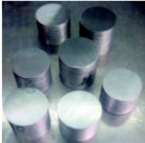
Figura 2.32. Muestras después del desbaste fino. (Fuente: Propia)
