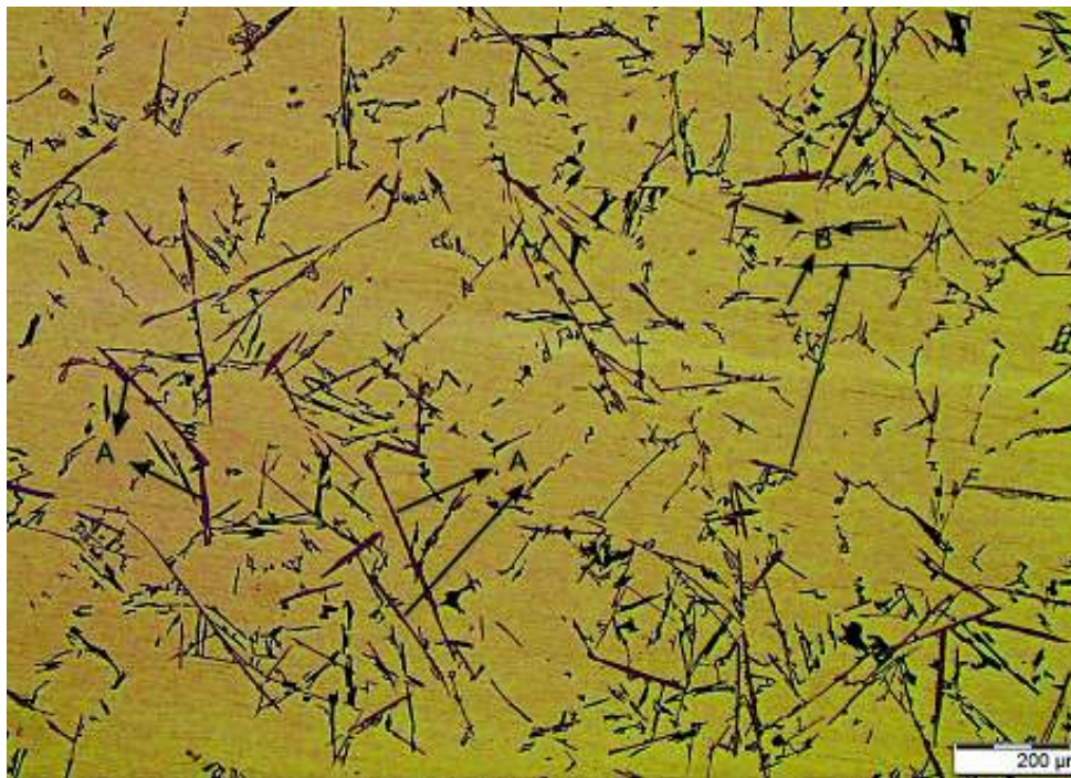
Figura 3.9. Plaquetas \beta en muestra con 1% de Fe, las plaquetas marcadas con A son aquellas formadas antes de la reacción eutéctica (las más largas y gruesas), las del grupo (B) son aquellas formadas después o durante la reacción eutéctica (cortas y delgadas). (Fuente: Propia)
