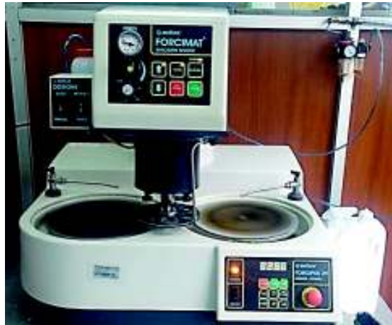
Figura 2.30. Máquina para la preparación superficial de muestras para análisis metalográfico. (Fuente: Propia)
