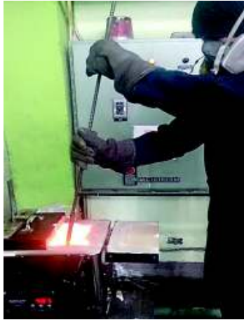
Figura 2.15. Adición de desgasificante (APARTAGAS) por inmersión con ayuda de una campana de hierro. (Fuente: Propia)
