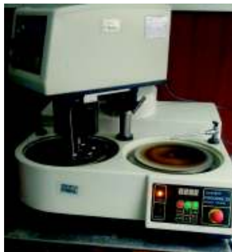
Figura 2.31. Desbastado rotatorio de muestras de aleación de aluminio. (Fuente: Propia)
