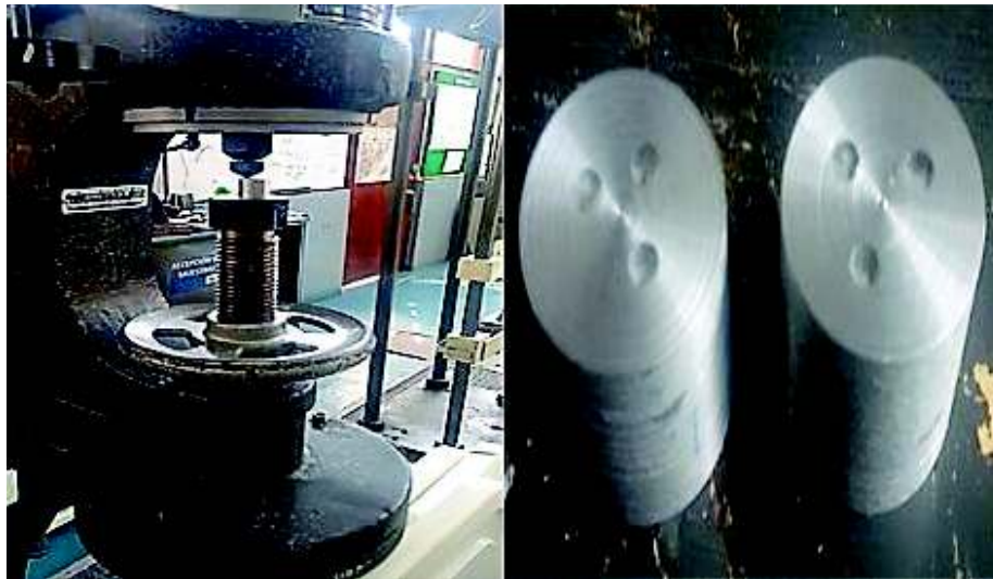
Figura 2.23. Medición de dureza Brinell (resultado de la indentación en las muestras). (Fuente: Propia)
