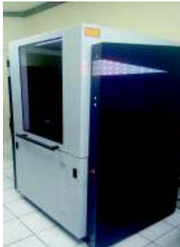
Figura 2.37. Difractómetro de Rayos X D8 ADVANCE marca BRUKER. (Fuente: Propia)
