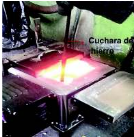
Figura 2.13. Adición de refinador de grano a 750°C con ayuda de una cuchara de hierro. (Fuente: Propia)
