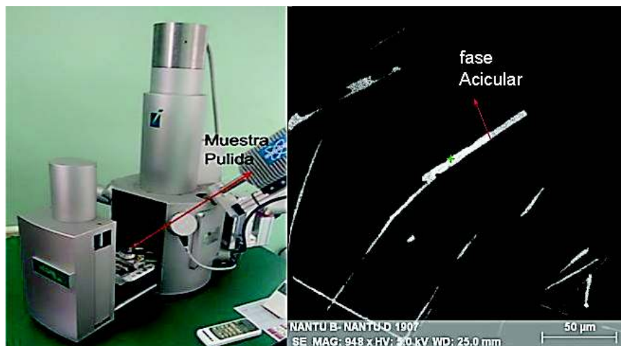
Figura 2.35. Análisis de composición química puntal en el microscopio electrónico de barrido de una aguja o plaqueta en una muestra de aleación A 356 con alto contenido de hierro. (Fuente: Propia)
