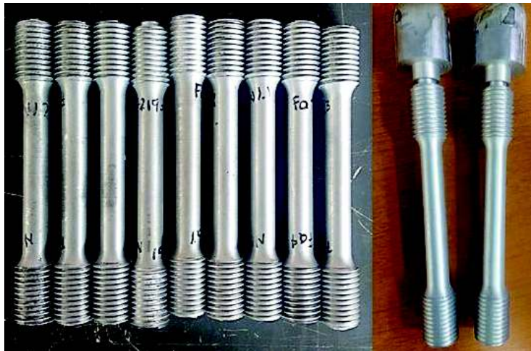
Figura 2.3. Probetas obtenidas al aumentar la temperatura de calentamiento del molde metálico. (Fuente: Propia)
