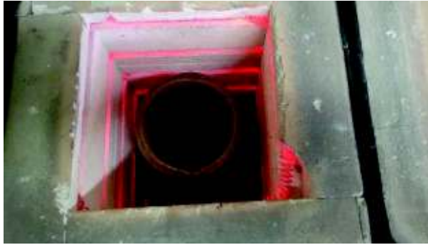
Figura 2.8. Eliminación de humedad y calentamiento del horno y crisol. (Fuente: Propia)
