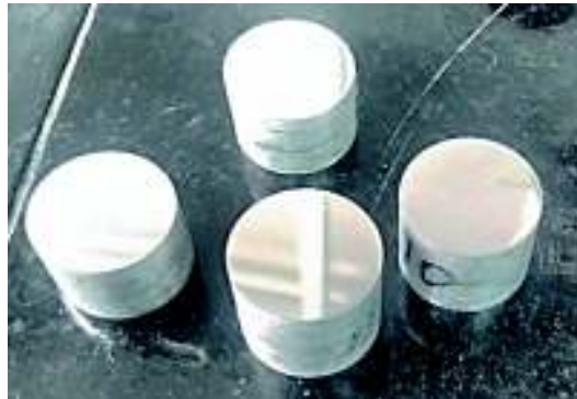
Figura 2.26. Probeta para medición de dureza Vickers (superficie ensayada pulida). (Fuente: Propia)
